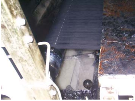
Şekil 2.3. Haşıl makinesinde gerçekleşen haşılama işlemi
