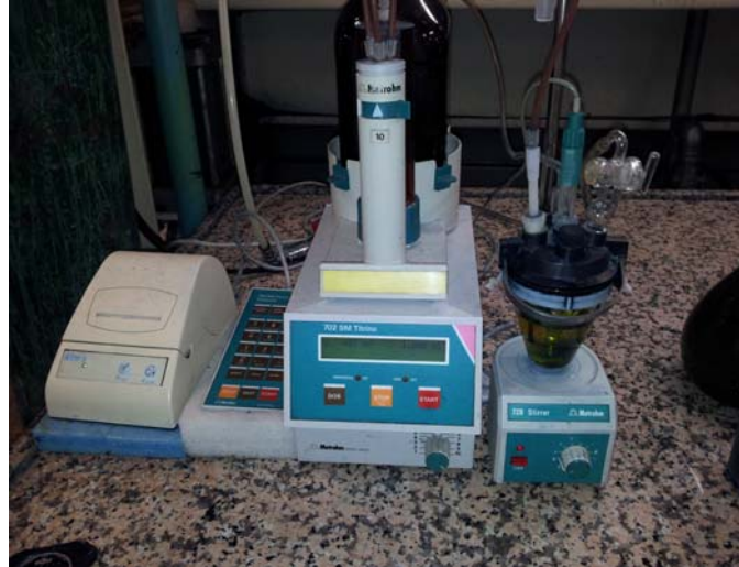
Şekil 4.7. Geri kazanılan boya miktarından hazırlanan çözeltinin metrohm cihazı ile ölçülmesi
