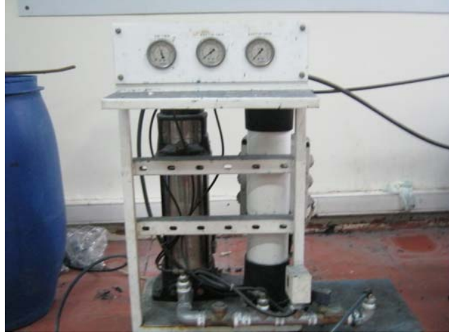
Şekil 4.2. Ters ozmos ünitesi (TO membranı, basınç motoru ve basınç göstergesi)
