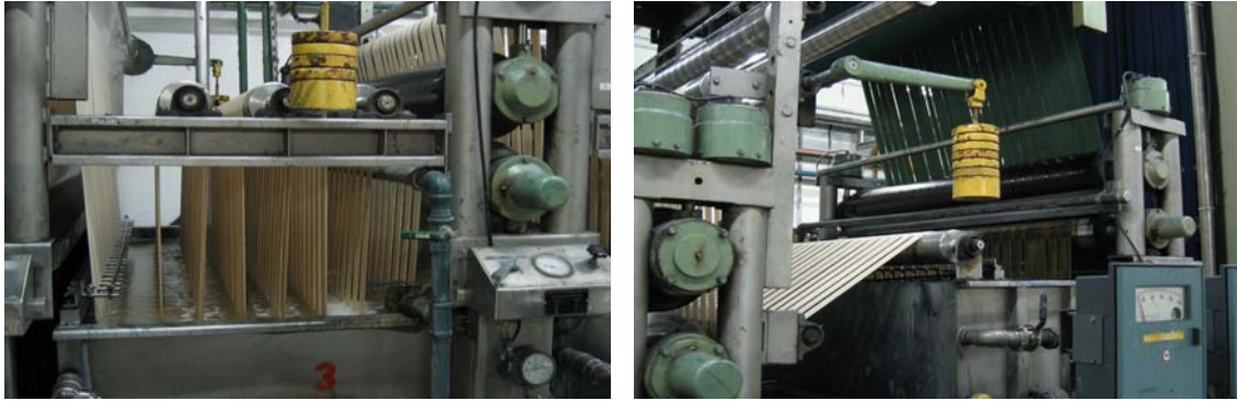
Şekil 2.2. İndigo boya makinesinde ipliklerin boyama işlemi
