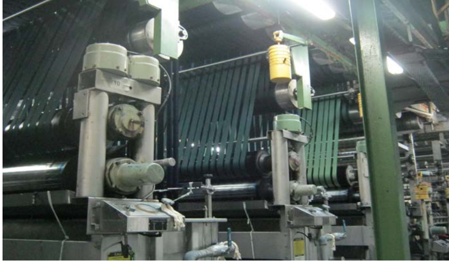
Şekil 4.6. İndigo boya makinesindeki teknelerden boyanan ipliğin görüntüsü
