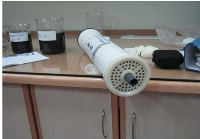
Şekil 4.4. TO değiştirilen membran
