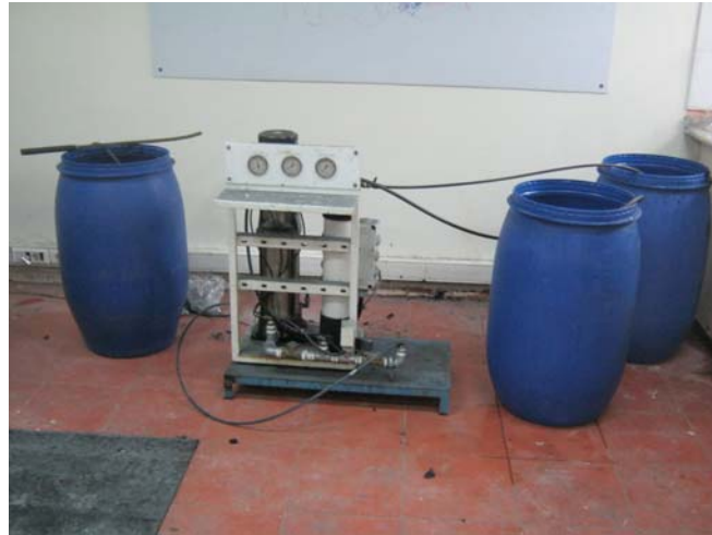
Şekil 4.3. TO membran ile deney düzeneği
