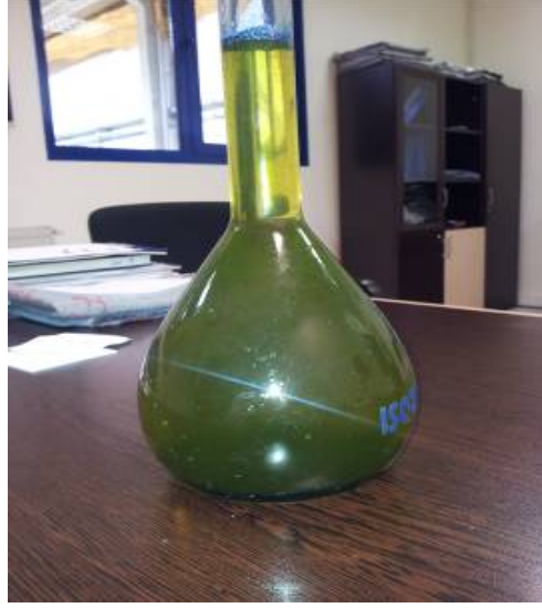
Şekil 4.8. Oksijenle yükseltgenerek silindirlerden kazıyarak aldığımız boya kalıntılarının indirgenme işlemi
