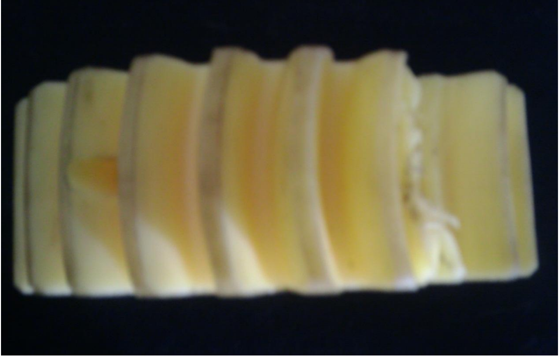
Şekil 4.8. Eğri dişlinin kırılması
