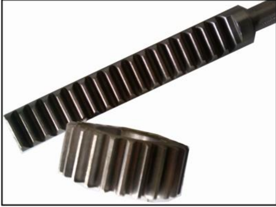
Şekil 3.40. St60'tan imal edilmiş düz dişli çifti
