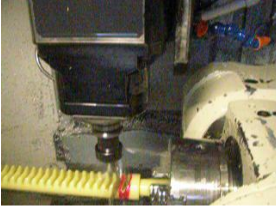
Şekil 3.37. Ok kremayer dişlinin son paso işlenmesi
