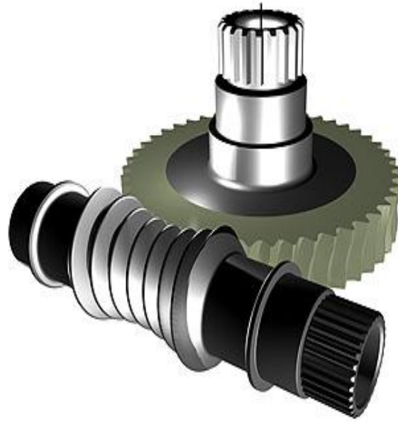
Şekil 2.12. Globoid sonsuz vida mekanizması
