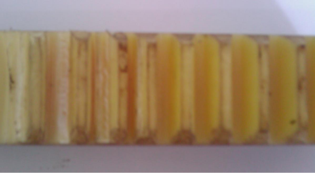
Şekil 4.5. Düz dişli kremayerinin kırılması
