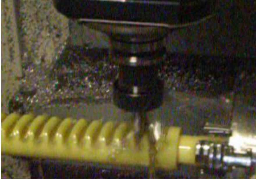
Şekil 3.34. Konkav-konveks kremayer dişlinin kaba işlenmesi
