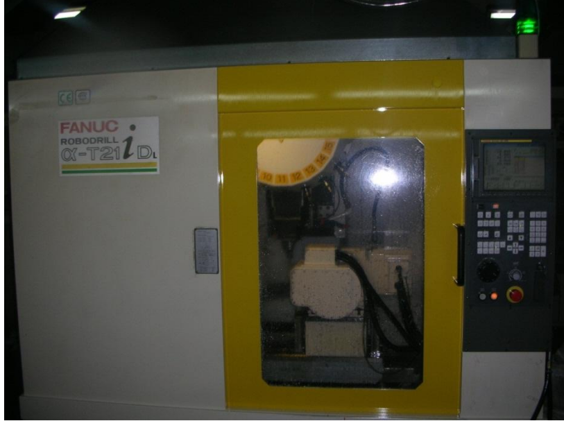
Şekil 3.29. FANUC marka beş eksen CNC freze tezgahı.
