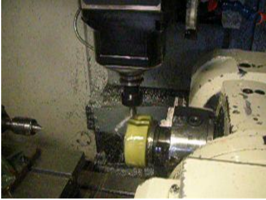
Şekil 3.36. Ok dişlinin son paso işlenmesi
