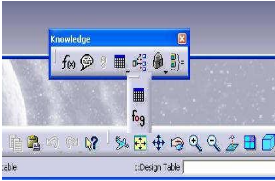
Şekil 3.6. CATIA katı model oluşturmak için formül girme menüsü
