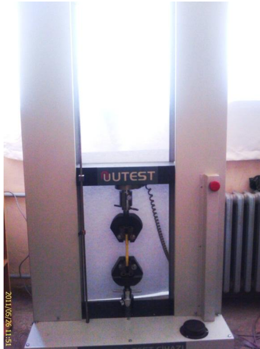
Şekil 3.21. Çekme deney tezgahı
