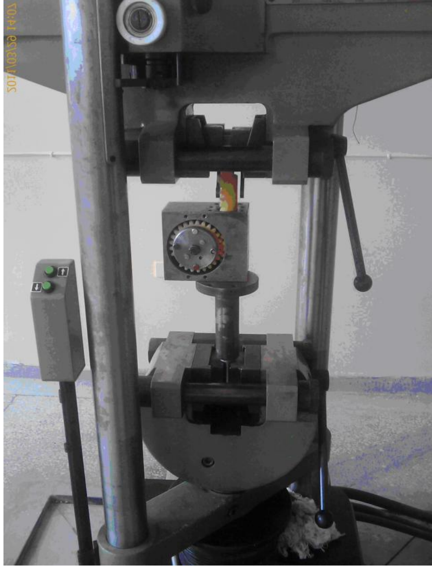
Şekil 4.3. Dişlilerin çekme cihazına bağlanma ve çekme şekli
