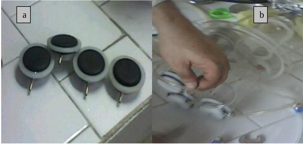
Resim 2. 1. Sistemde kullanılan membran difüzörler (a) ve bağlantıları (b).
