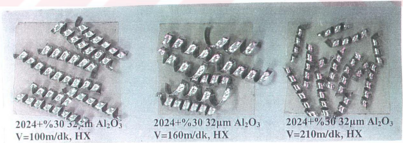
Foto 5.36. 2024Al+% 30 32 µm Al 2 O 3 Kompozitin HX Takımıyla 100, 160 ve 210 m/dk Kesme Hızlarında İşlenmesi Sonucu Oluşmuş Talaş Yapıları
