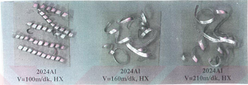
Foto 5.35. Matriks 2024Al Alaşımının HX Takımıyla 100, 160 ve 210 m/dk Kesme Hızlarında İşlenmesi Sonucu Oluşmuş Talaş Yapıları
