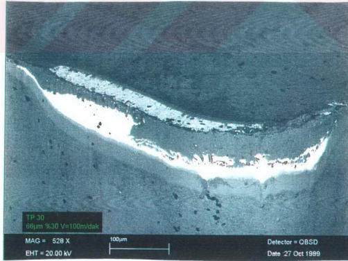
Foto 5.20. K10 ve TP30 Kesici Takımlarının 2024Al+% 30 66 \mu\text{m} \text{Al}_2\text{O}_3 Kompozitin V=100 m/dak Kesme Hızında İşlenmesinden Sonra Çekilmiş Aşınan Yan Yüzey Back Scattering SEM Fotoğrafları (a) K10, (b) TP30
