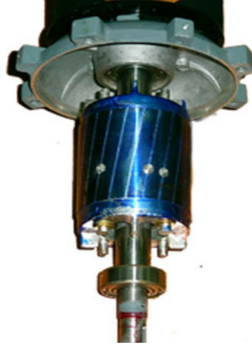
Şekil 1.7. Üç adet kırık rotor çubuğuna sahip rotor
