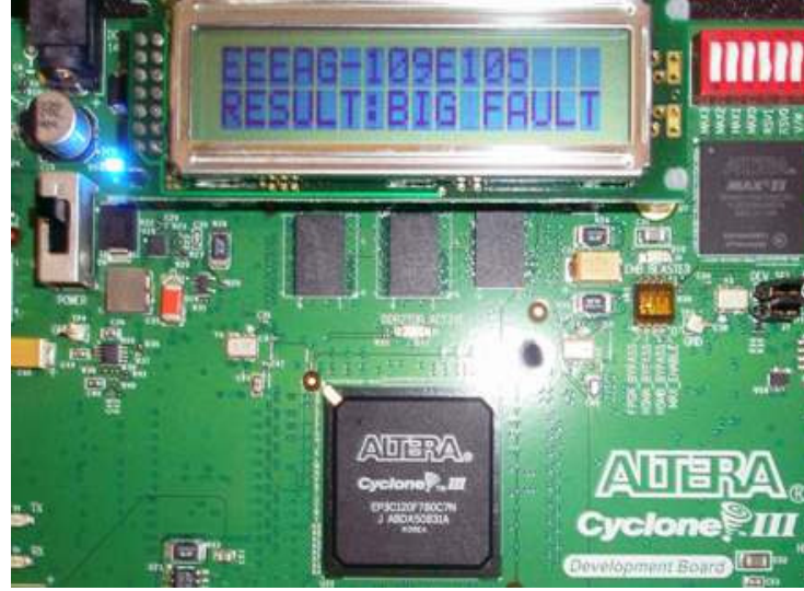
Şekil 6.21. Bulanık sistemin FPGA uygulaması
