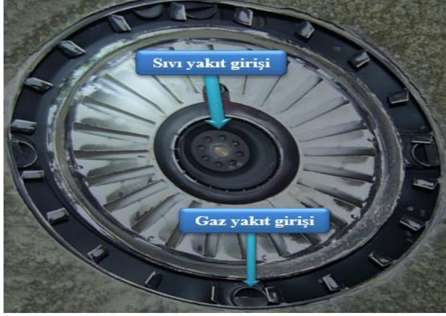
Şekil 2.9. Brülörün fırın içerisinden görünüşü
