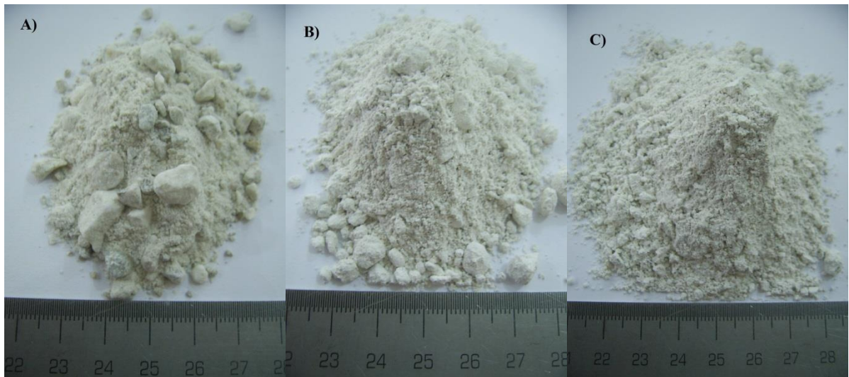
Şekil 2.4. A) Döner fırın girişi, B) Döner fırın çıkışı, C) Değirmen Çıkışı
