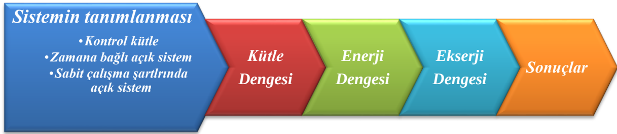
Şekil 2.19. Ekserji analizlerinde izlenen yol
