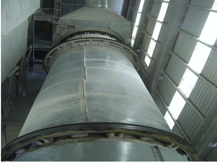
Şekil 2.7. Döner fırının döndürülen bölümü
