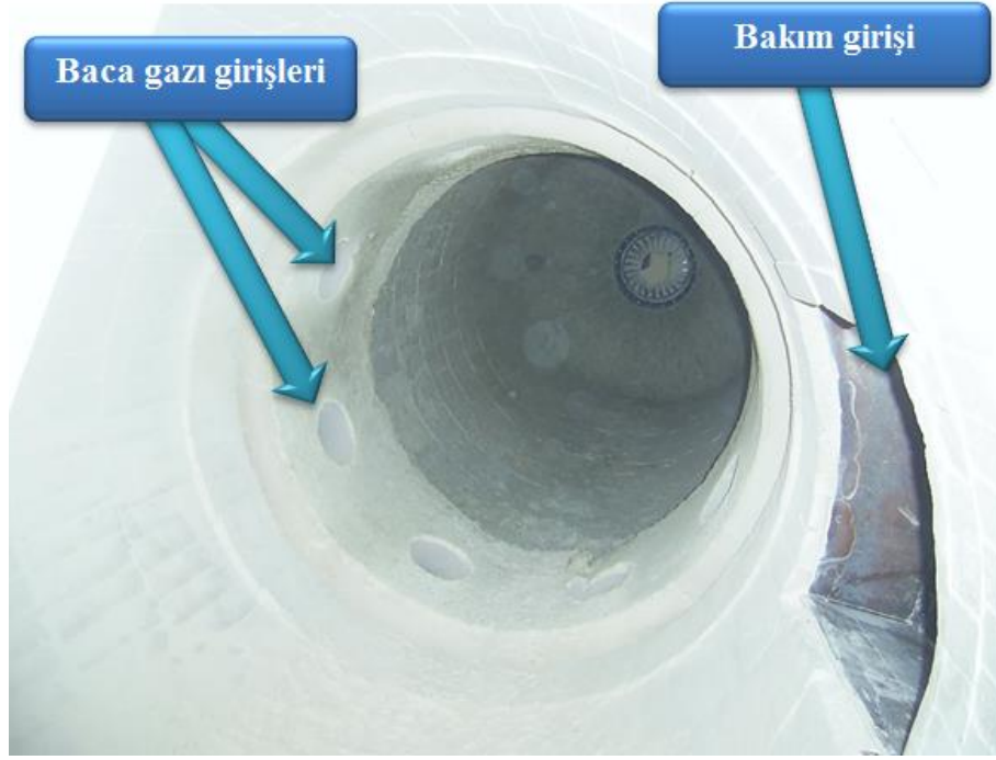
Şekil 2.12. Baca gazının fırına giriş bölümü
