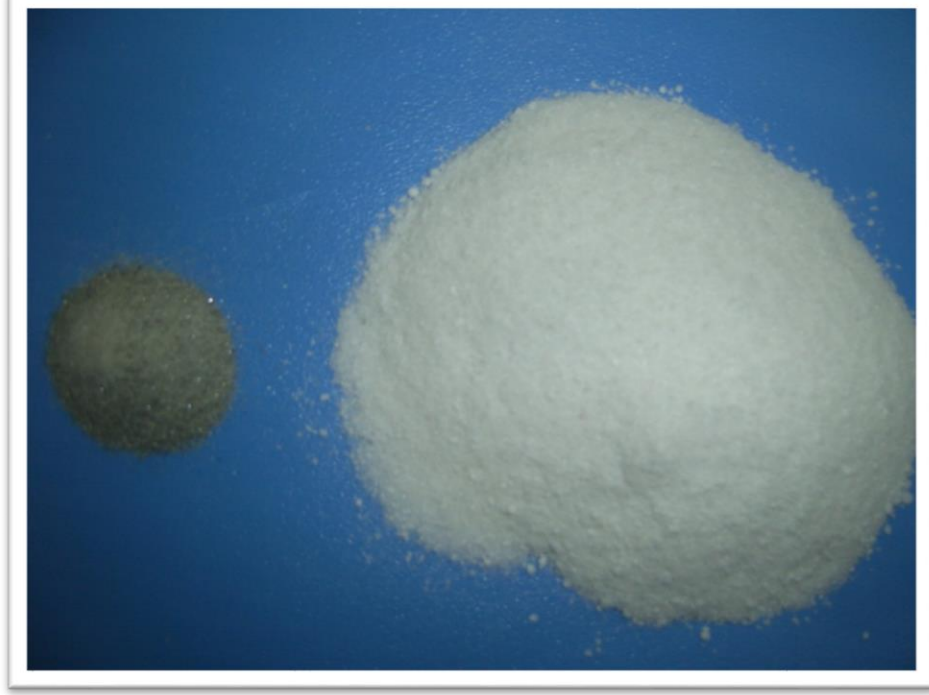
Şekil 2.18. Ham perlit ile genişletilmiş perlit arasındaki hacimsel fark
