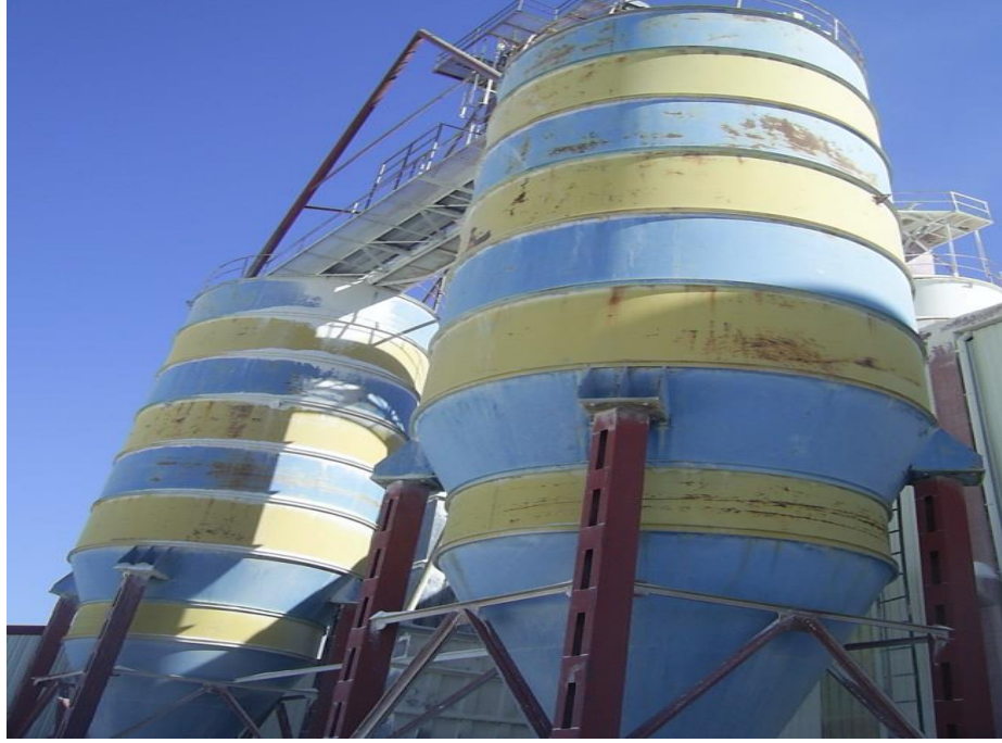
Şekil 2.3. Her biri 250 ton kapasitedeki hammadde siloları
