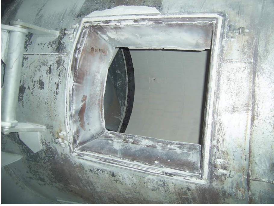
Şekil 2.10. Döner fırının bakım girişı
