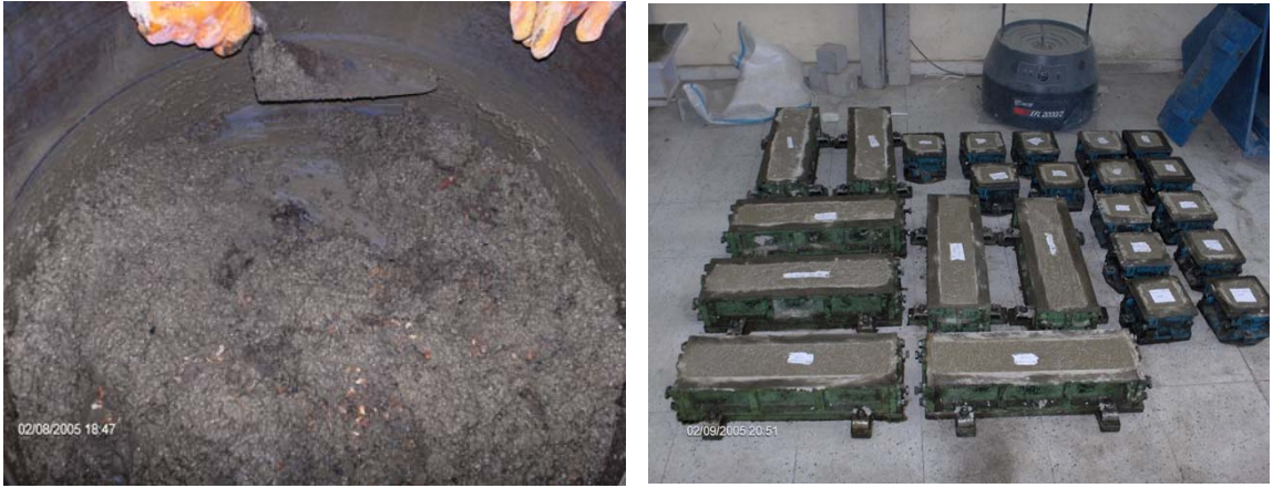
Şekil 6.2 Numunelerin hazırlanması ve kalıplara yerleştirilmesi
