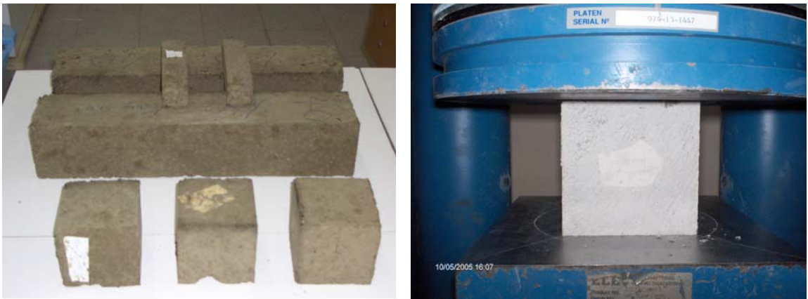
Şekil 6.3 Kalıplardan çıkarılmış numuneler ve basınç presine yerleştirilmesi
