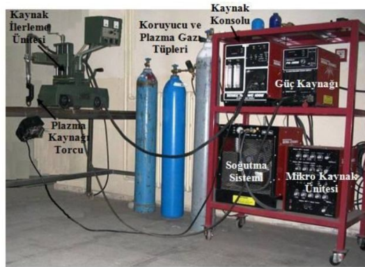
Şekil 29. Thermal Dynamic/Arc PTA kaynak makinesi koruyucu gaz tüp bağlantıları ve kontrol paneli
