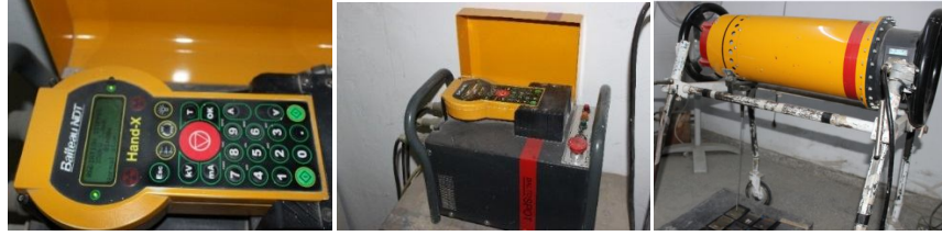
Şekil 31. Kontrol paneli, Güç kaynağı ve Işınım cihazı
