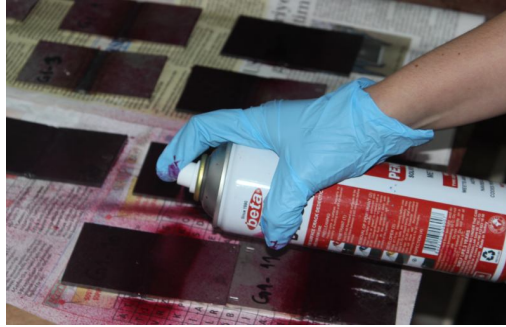
Şekil 34. Püskürtme yöntemi ile penetrant uygulanması.
