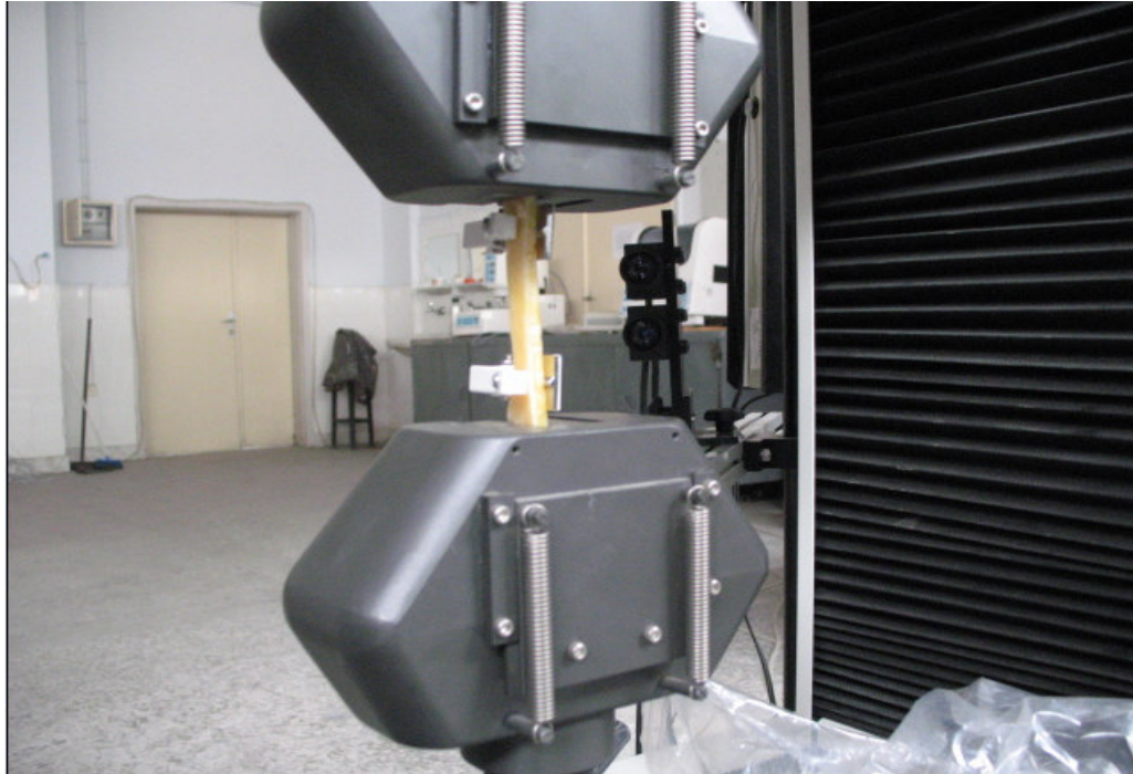
b) Bulk numunelerin çekilmesinde kullanılan universal (SHIMADZU) çekme cihazının yan görünüşü
