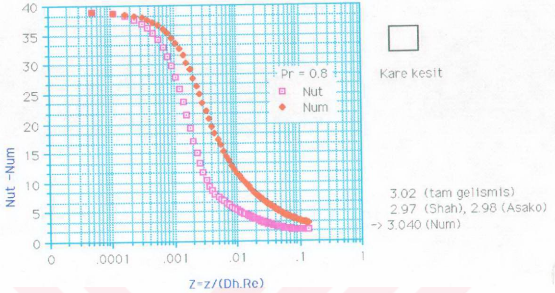
Grafik 42. Baklava kesitli ( \alpha=90^\circ ) kanalda giriş bölgesi boyutsuz Nusselt sayısının akış yönündeki değişimi.
