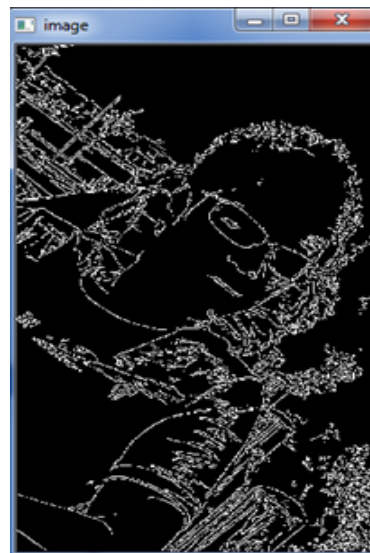
(b) Canny Kenar Bulma yöntemi uygulanmış resim
