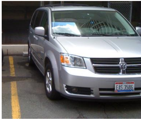
Şekil 5.20 Gündüz ışığında dışarıdan alınan görüntülerde camdaki yansımalar
