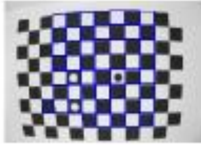
Şekil 5.29 Kalibrasyon nesnesinde kare tespiti
