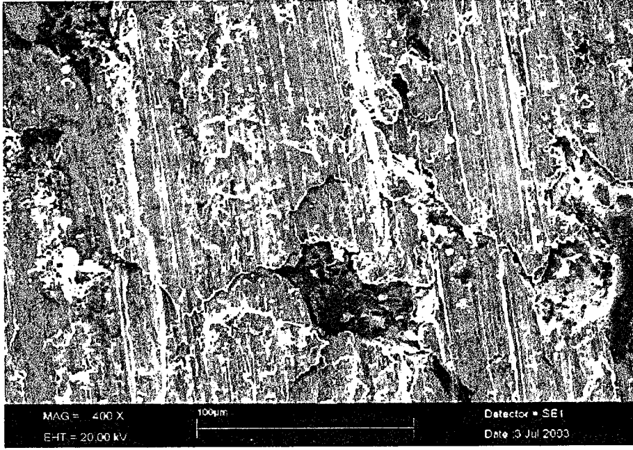
Şekil 6.38. 6 nolu numunenin 10N yük altında aşınma yüzeyinin SEM fotoğrafı.
