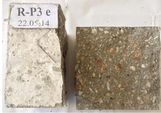
Şekil 5.49. Yarma deneyi sonucunda kırılan numune
