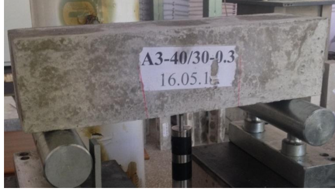
Şekil 5.63. Küçük kiriş numunesinin eğilme deneyi
