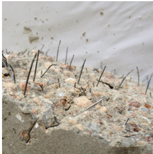
Şekil 5.60. Eğilme deneyi sırasında betondan sıyrılarak çıkan çelik lifler
