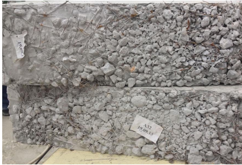
Şekil 5.10. A32 granülometrisine sahip beton numunelerin yüzey durumları
