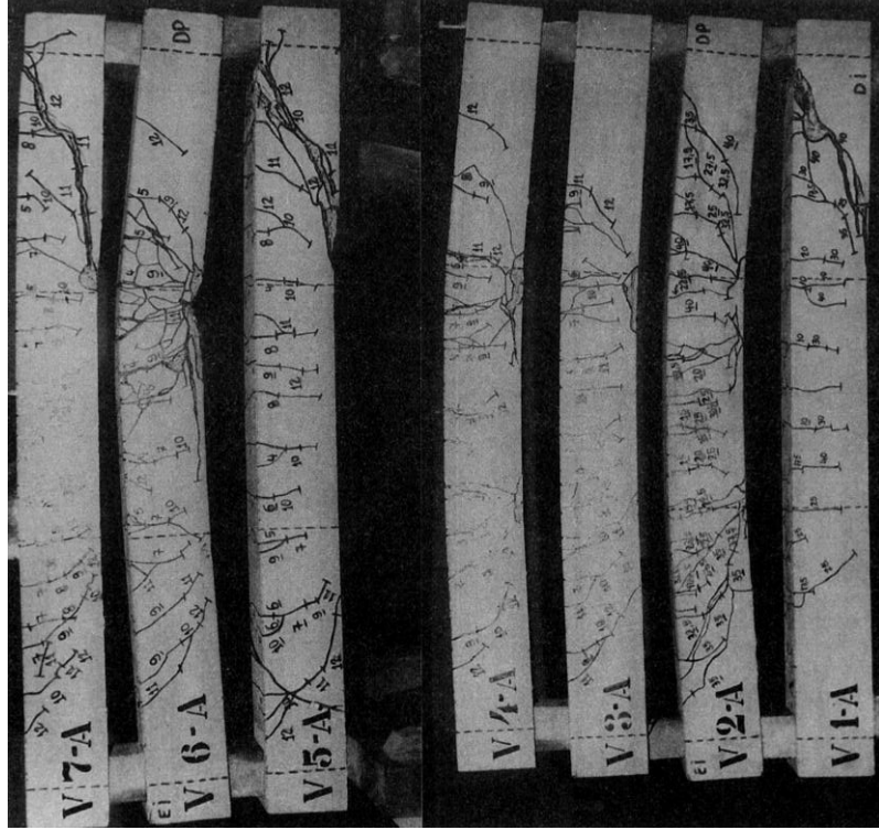
Şekil 2.22. Enine donatı bulunduran çelik lifli betonarme kirişler (Furlan ve Bento de Hanai, 1997).
