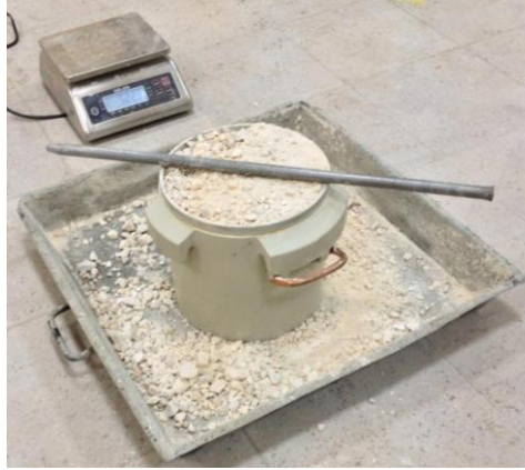
Şekil 4.9. Agregalar arası boşluk oranının bulunması
