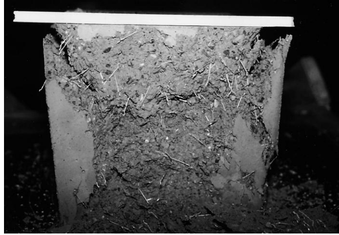
Şekil 2.14. Basınç deneyi sonucunda ÇLDB numunesinde meydana gelen çatlaklar (Ding ve Kusterle, 2000).
