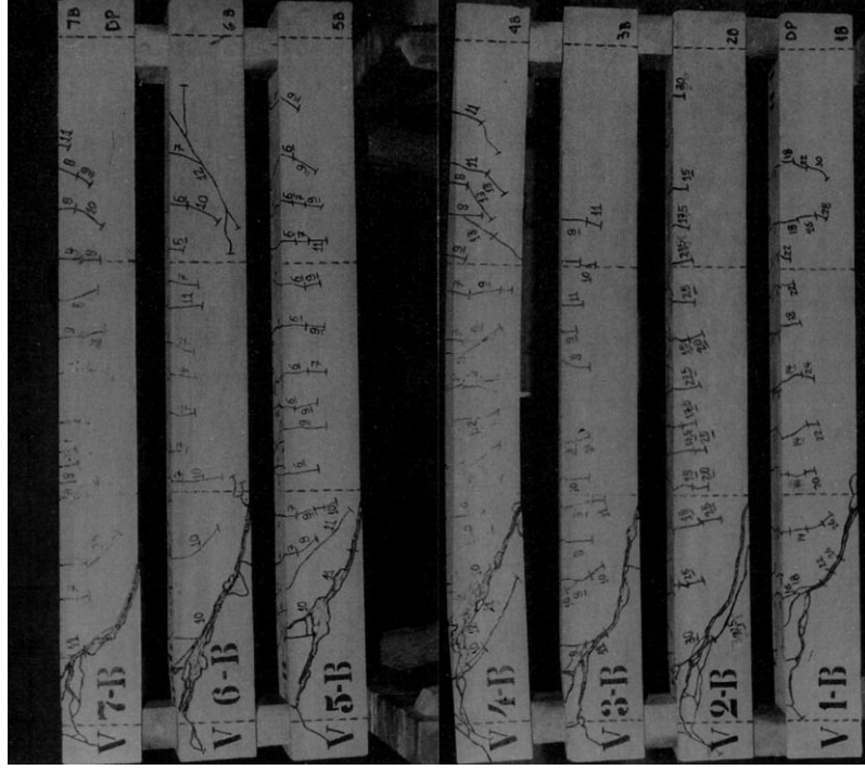
Şekil 2.23. Enine donatı bulundurmeyen çelik lifli betonarme kirişler (Furlan ve Bento de Hanai, 1997).
