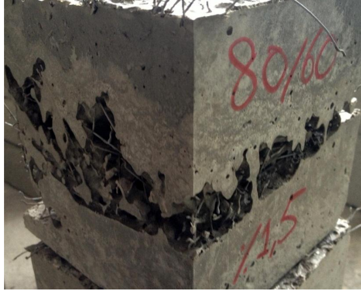
Şekil 2.12. Fazla miktarda, uzun çelik lif içerdiğinden bünyesinde ciddi yerleşme boşlukları meydana gelmiş standart bir küp numunesi (Açıkgenç vd., 2013).
