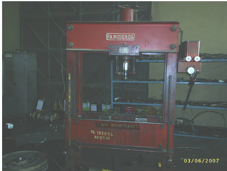
Şekil 5.1. Kompozit malzemeleri üretmek için kullanılan soğuk pres.
