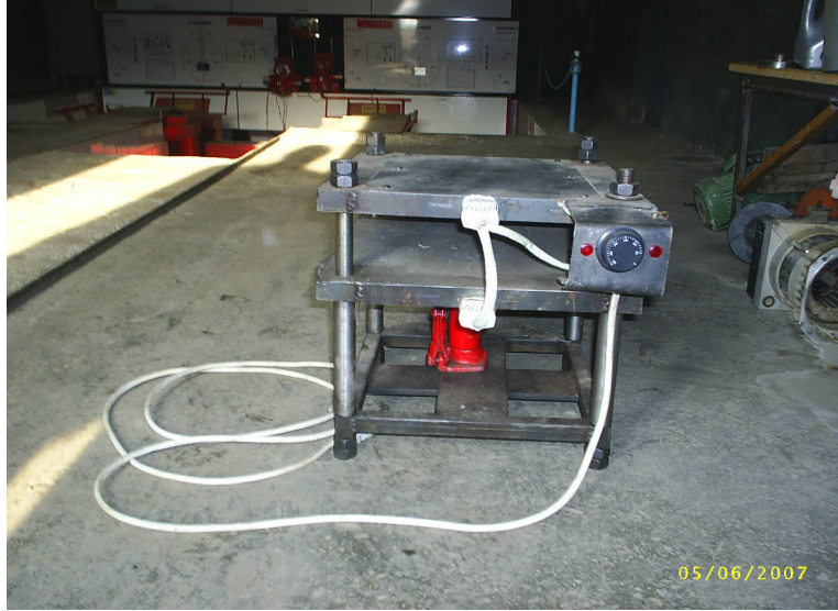
Şekil 5.2. Kompozit malzemeleri üretmek için kullanılan sıcak pres.
