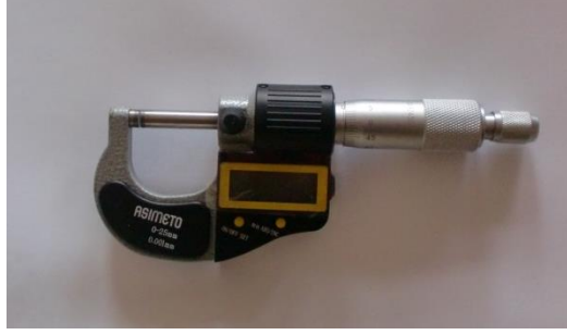
Şekil 2.5. Film kalınlıklarının ölçülmesinde kullanılan dijital mikrometre
