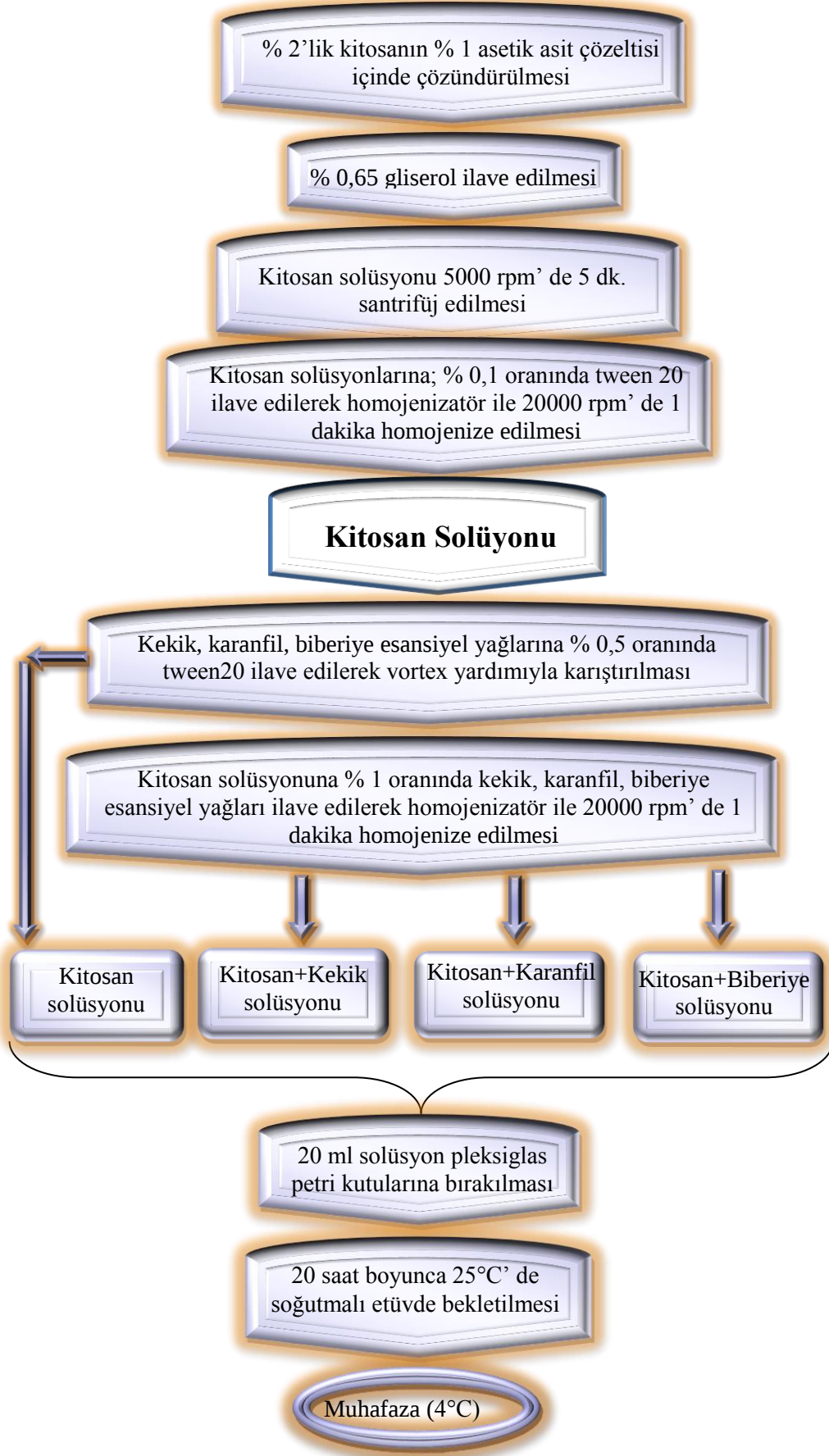
Şekil 2.4. Yenilebilir filmlerin hazırlanmasındaki işlem akış şeması
