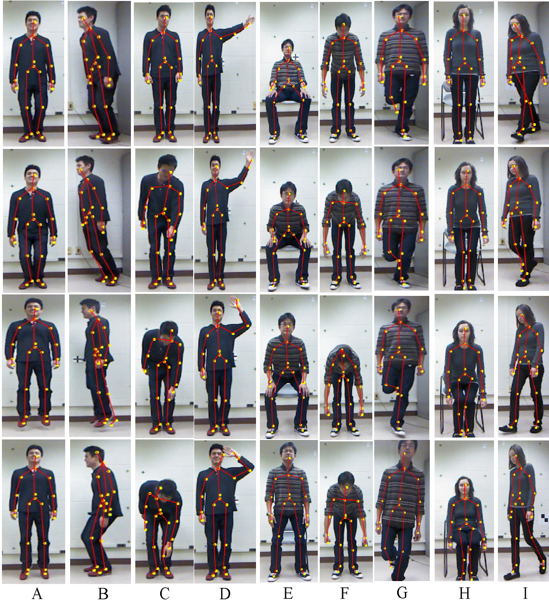
Şekil 4.2. Zıplama (A) , ileri zıplama (B), bir nesneyi alma (C), el sallama (D), kalkma (E), kaldırma (F), sekme (G),sekme (G), oturma (H), yürüme (I) hareketi ve eklemlerin iskelet modeli
