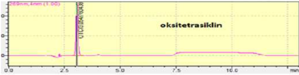
Şekil 5.3. Yüksek Performanslı Sıvı Kromatografisi (HPLC) ve Oksitetrasiklin (OTC) Kromotogramı
