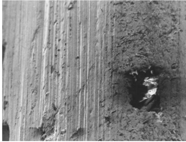
Şekil 7.5. Aşınmış soketin mikroyapısı ve aşınma izleri (Konstanty, 2005).
