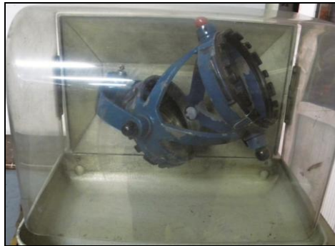
Şekil 8.2. Matris tozu karıştırma mikseri.
