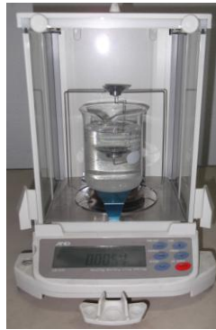
Şekil 8.7. Yoğunluk ölçme terazisi (AND GR-200)
