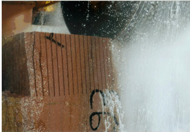
Şekil 2.8. Dairesel testerelelerde kesme sırasında su kullanımı (Özçelik vd., 2008).
