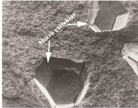
Şekil 6.4. Sinterleme sonrası matriste oluşan mikro çatlaklar (Konstanty, 2005).
