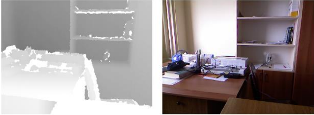
Şekil 2.1. Derinlik bilgisi alınan sahnenin içerdiği delikler
