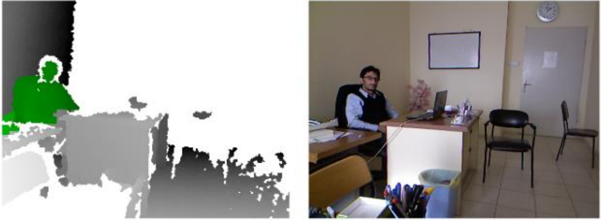
Şekil 4.2. Yakalanmış Kinect derinlik görüntüsü ve RGB görüntüsü
