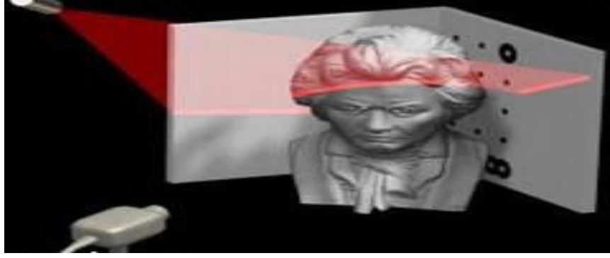
Şekil 2.2. Lazer tarama tekniği kullanılarak oluşturulmuş 3B modelleme [23].
