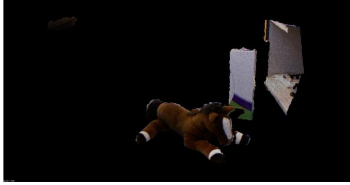
Şekil 4.12. Düzlem çıkarma (RANSAC) sonrası giriş verileri [16].
