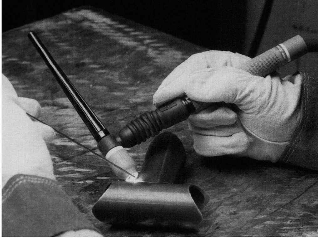
Şekil 3.6. (GTA) Gaz altı kaynak yöntemi ile bir kaynak uygulaması.
