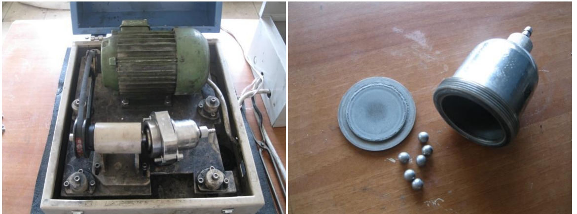
Şekil 2.5. (a) Titreşimli bilyalı değirmen, (b) karıştırıcı hazne [2].
