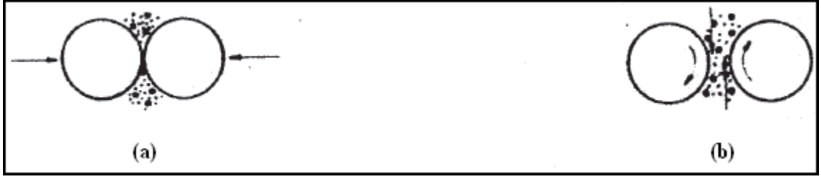
Şekil 2.8. Atritör değirmeninde öğütme esnasında oluşan hareketler, (a) darbe, (b) kesme.
