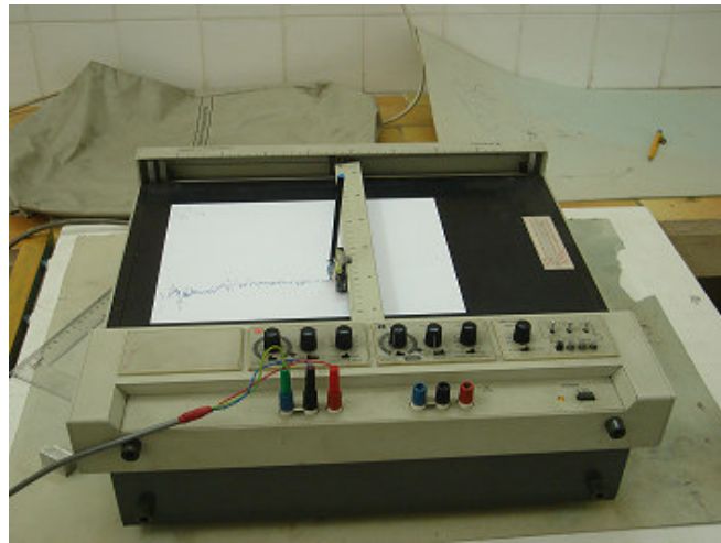
Şekil 5.5. Aşınma sırasında sürtünme katsayısını grafik olarak tespit etmemizi sağlayan çizici.
