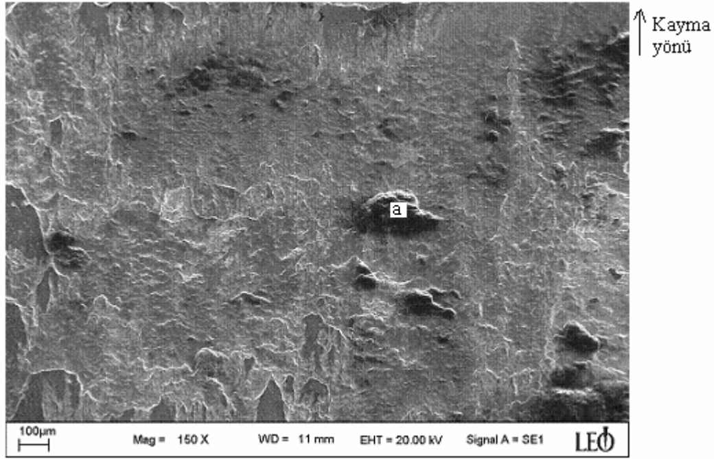
Resim 6.19. 83N’da aşındırılan %10Ni 3 Al takviyeli Cu matrisli numunenin aşınma sonrası yüzeyinin SEM fotoğrafı
