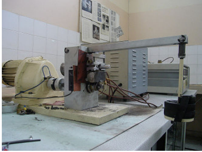
Şekil 5.2. TE53/80004 marka çok amaçlı sürtünme ve aşınma makinesi
