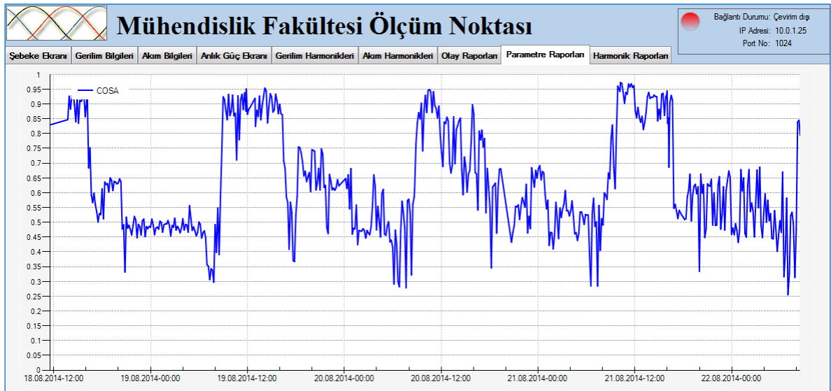
Şekil 5.18. Mühendislik Fakültesi ölçüm noktasının A fazına ait güç faktörü bileşeninin değişim grafiği.
