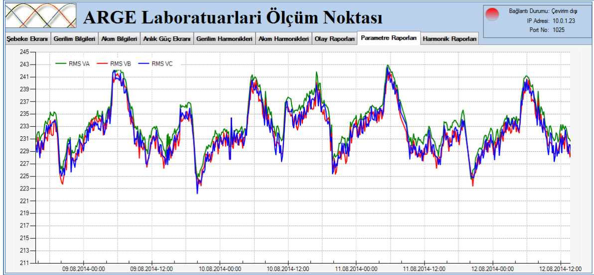
Şekil 5.6. 08.08.2014-13.08.2014 tarihleri arasında AR-GE Laboratuvarları ölçüm noktasındaki gerilim etkin değerlerinin 10’ar dakikalık aralıklarla değişimi.
