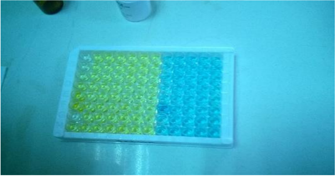
Şekil 2.13. Stop solisyonu eklendikten sonra kuyulardaki renk değişimi
