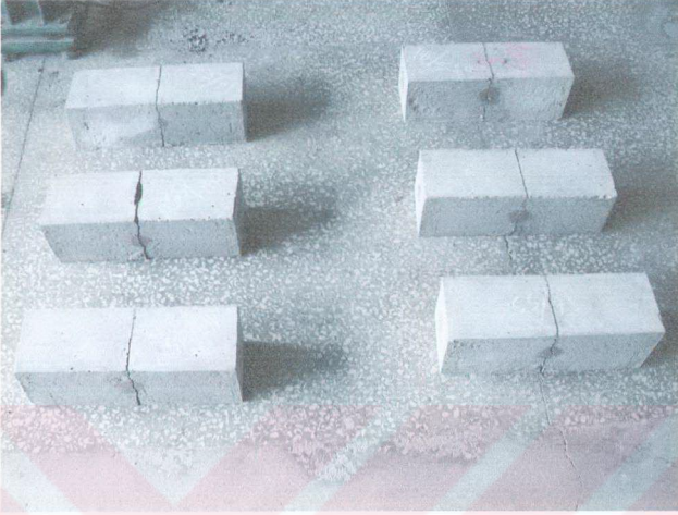
Şekil 5.14 Kırılmış kirişlerin kırılma düzlemleri ( d_{max} = 16 mm, 550 doz )
