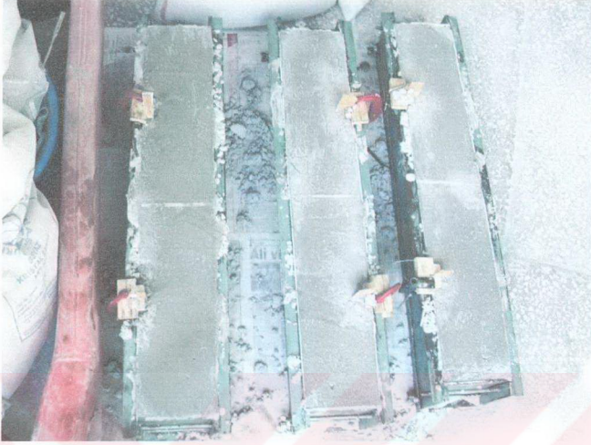
Şekil 5.7 Kalıplara yerleştirilmiş beton numuneler
