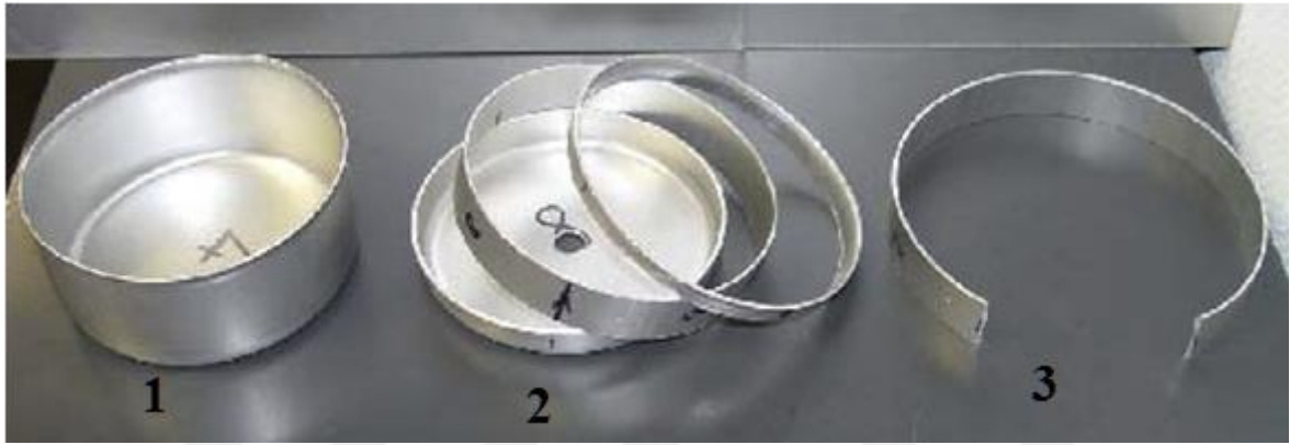
Şekil 3.19. Split- ring testi; 1) çekilmiş kap, 2) açılmış halka (split-ring), 3) bilezik alındıktan sonra kabın alt ve üst kısmı[98]
