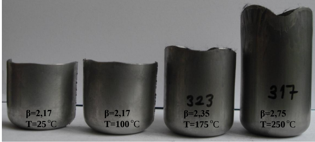
Şekil 5.34. 3600 N BPK ve \alpha=5^\circ deneylerinden elde edilen numuneler
