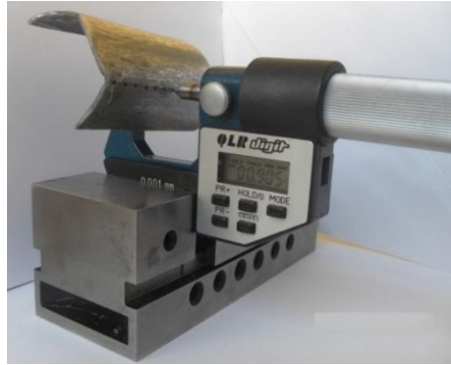
Şekil 5.50. Et kalınlıklarının ölçülmesi
