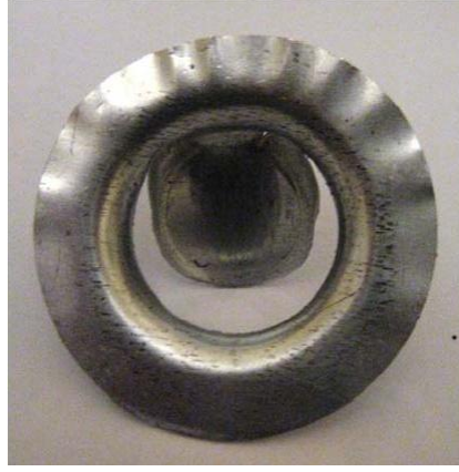
Şekil 3.9. Çekme oranının büyük olmasından dolayı parçada meydana gelen yırtılma [78]
