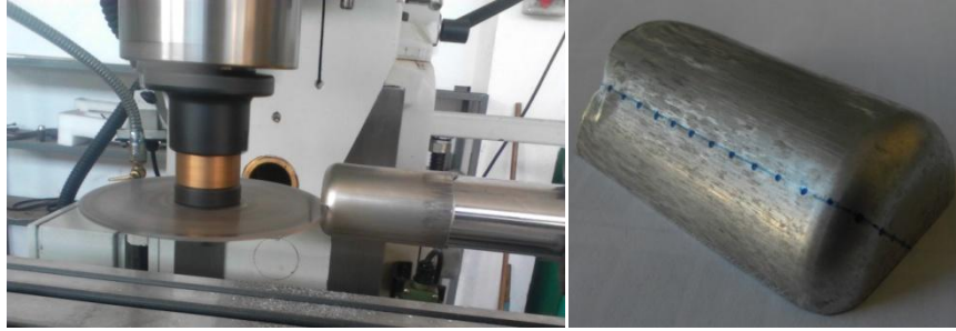
Şekil 5.49. Et kalınlığı ölçümü için hazırlanan numune
