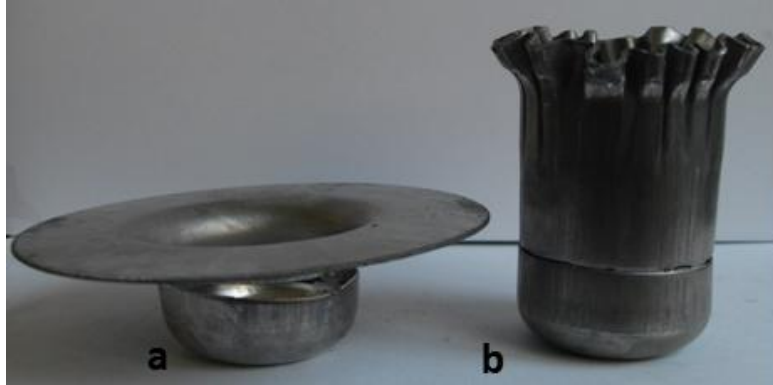
Şekil 5.70. Çekilen kaplarda oluşan yırtılma(a) ve buruşma(b) hataları
