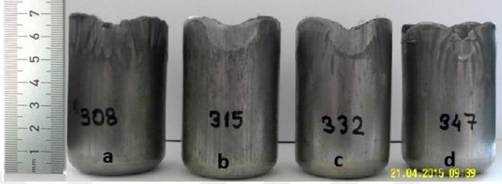
Şekil 5.71. \beta=2,75 için 250^\circ\text{C} ve 1200\text{ N} baskı plakası kuvvetinde elde edilen numuneler, a) \alpha=0^\circ b) \alpha=5^\circ c) \alpha=10^\circ d) \alpha=15^\circ
