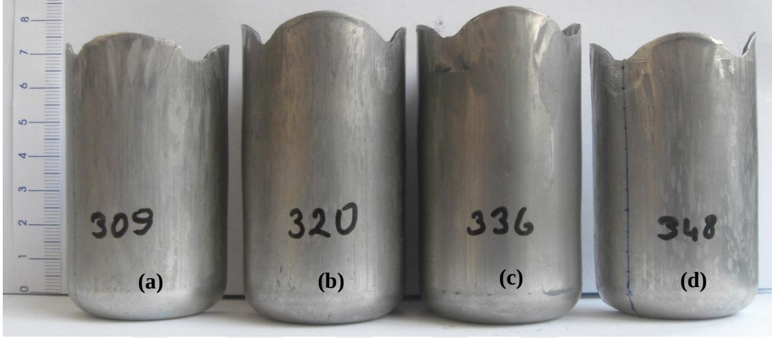
Şekil 5.20. 250 °C ve 2400 N BPK sonucunda elde edilen numuneler a) \alpha=0^\circ b) \alpha=5^\circ c) \alpha=10^\circ d) \alpha=15^\circ
