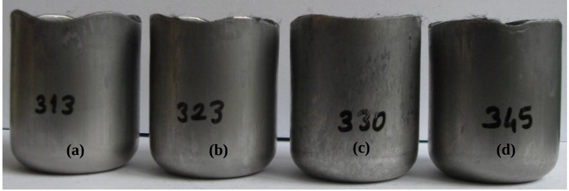
Şekil 5.16. 175 °C ve 3600 N BPK sonucunda elde edilen numuneler a) \alpha=0^\circ b) \alpha=5^\circ c) \alpha=10^\circ d) \alpha=15^\circ
