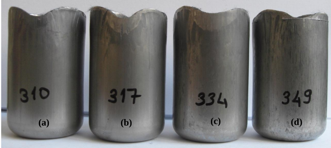
Şekil 5.22. 250 °C ve 3600 N BPK sonucunda elde edilen numuneler a) \alpha=0^\circ b) \alpha=5^\circ c) \alpha=10^\circ d) \alpha=15^\circ
