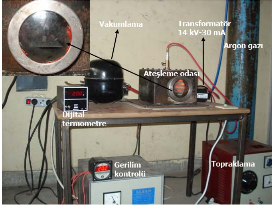
Şekil 6.2: Gözenekli NiTi ŞHA'nın üretiminde kullanılan ateşleme düzeneği. Numunenin yanına yerleştirilen ısı çifti ile numunenin ön ısıtma sıcaklığı dijital termometre ile ölçülmektedir. Isıtma hızı gerilim kontrolü ile ayarlanmakta, numune ise transformatör tarafından oluşturulan ark ile tutuşturulur.
