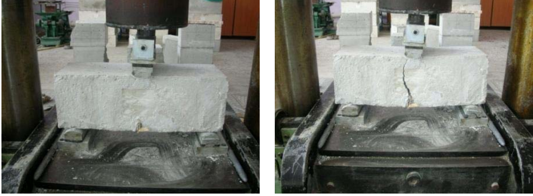
Şekil 5.29 Üç noktalı eğilme deneyi.
