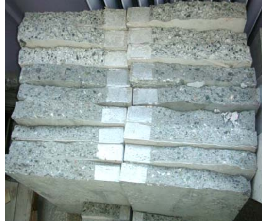
Şekil 5.16 Boyut etkisi numuneleri çeşitli görünüşler.
