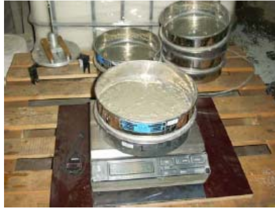
Şekil 2.12 Elek ayırışma direnci deney düzeneği.
