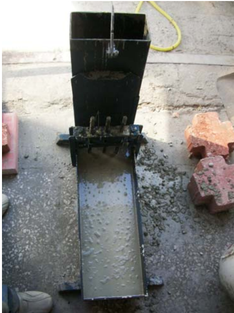
Şekil 2.9 a) L-kutusu deney düzeneği b) deneyin yapılışı.
