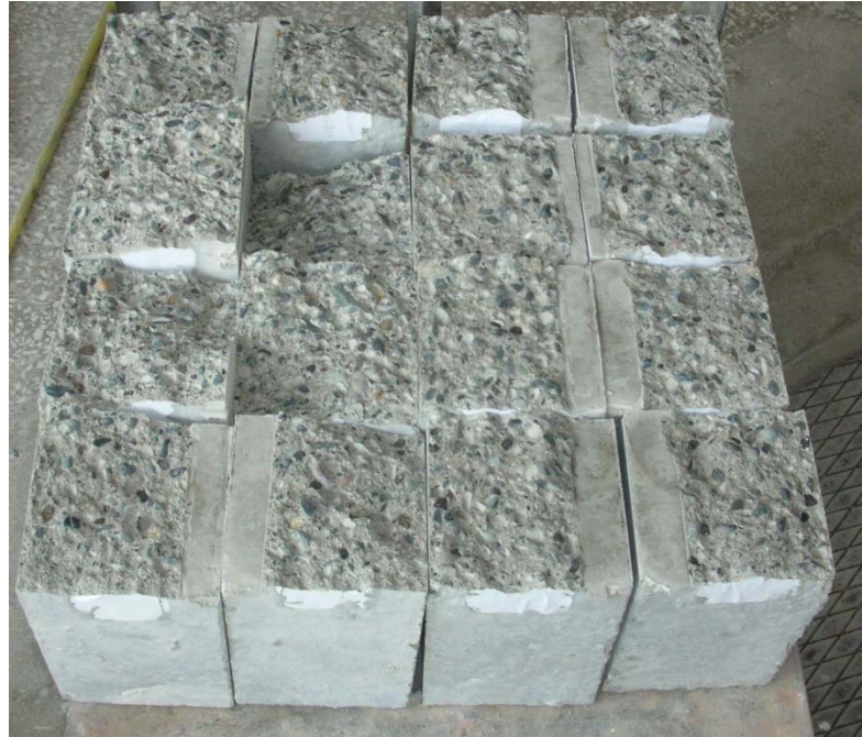
Şekil 5.30 Üç noktalı eğilme deneyinden sonra genel görünüş.
