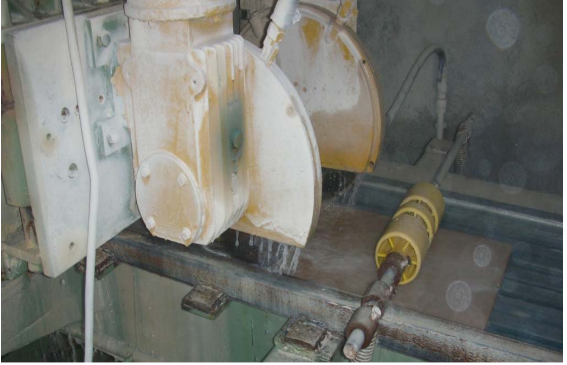
Şekil 4.2 Mermerlerin çeşitli boyutlarda kesilmesi.
