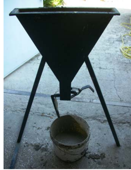
Şekil 2.8 V-hunisi deney düzeneği ve deneyin yapılışı.
