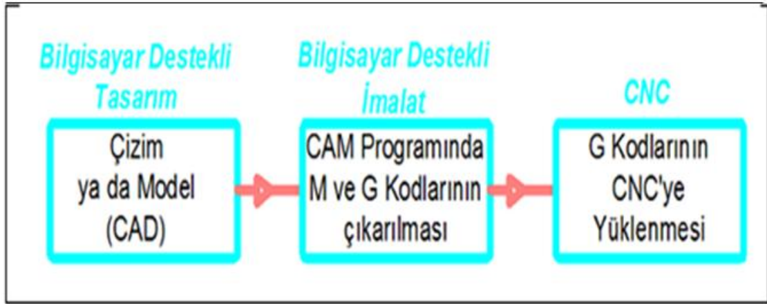
Şekil 2.2 Bilgisayar destekli M ve G kodlarının çıkartılacak CNC ara yüz programına yüklenme süreci [19]
