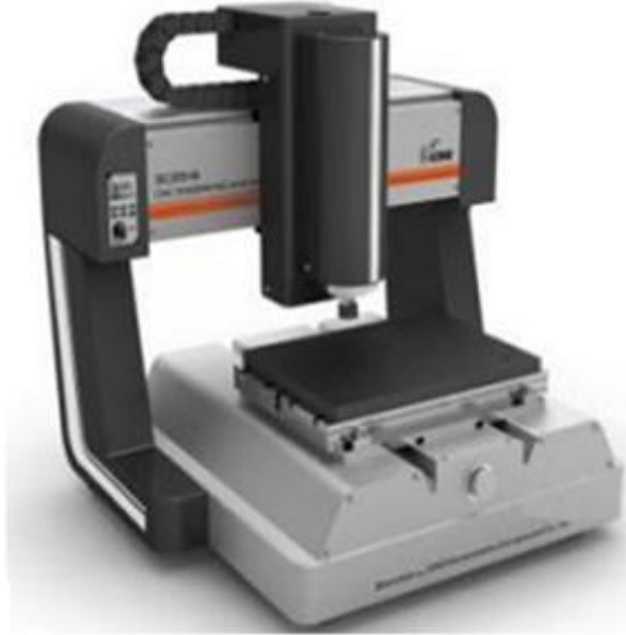
Şekil 2.1 Tabla hareketli masaüstü CNC freze [19]
