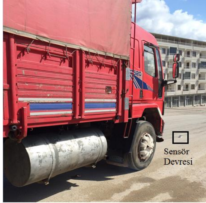
Şekil 5.19. Kamyonun sensör devresine yaklaşması
