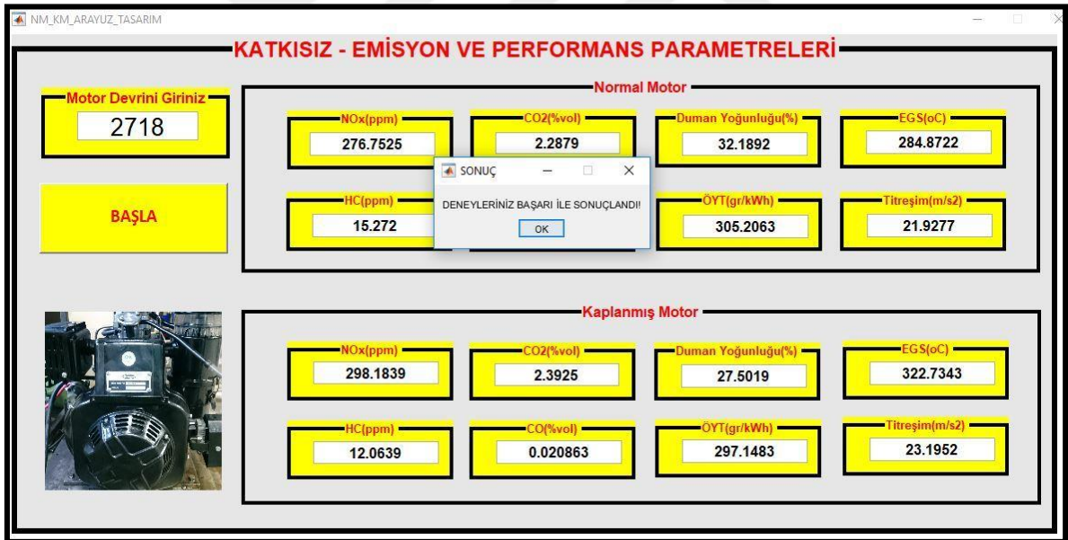
Şekil 7.24. NM ve KM' de, katkısız, 2718 dev/dk'deki emisyon ve performans parametrelerinin sonuçları
