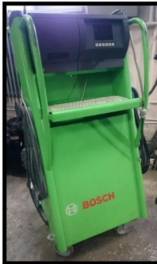
Şekil 7.3. Bosch marka emisyon ölçüm cihazı
