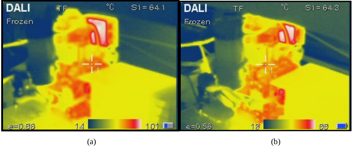
Şekil 8.250. (a) NM'nin katkısız termal görüntüsü, (b) NM'nin %3 DEGDE katkılı termal görüntüsü
