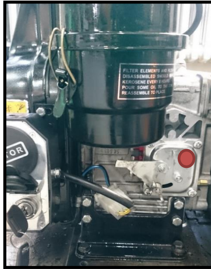
Şekil 7.6. Motor üzerinde titreřim ölçülerinin alındığı nokta (kırmızı nokta)
