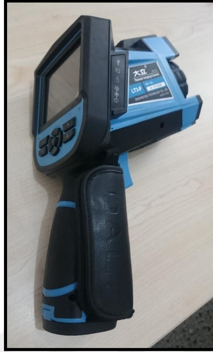
Şekil 7.7. DALI LT3-P marka termal kamera
