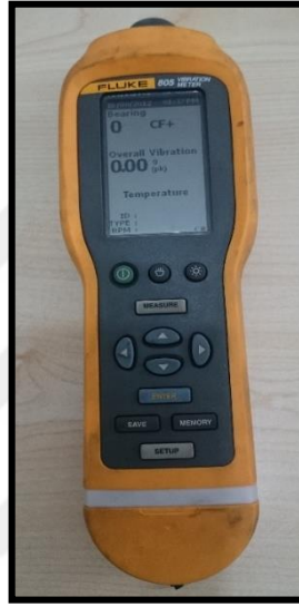
Şekil 7.5. Fluke 805 Marka titreřim ölçüm cihazı
