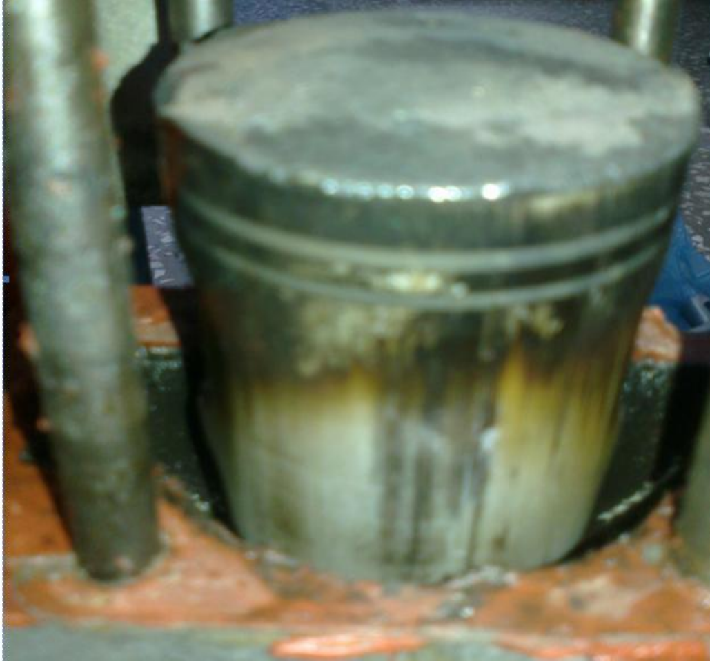
Şekil 5.4. Deney motorunun benzin-ayçiçek yağı karışımı ile çalıştırılması sonucu pistonun yandan görüntüsü
