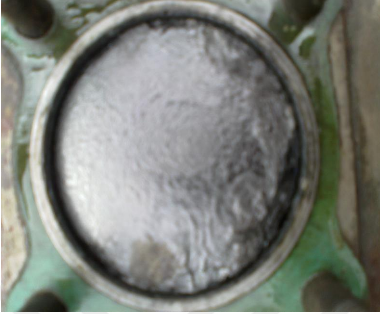
Şekil 5.5. Deney motorunun benzin-kanola yağı karışımı ile çalıştırılması sonucu piston görüntüsü
