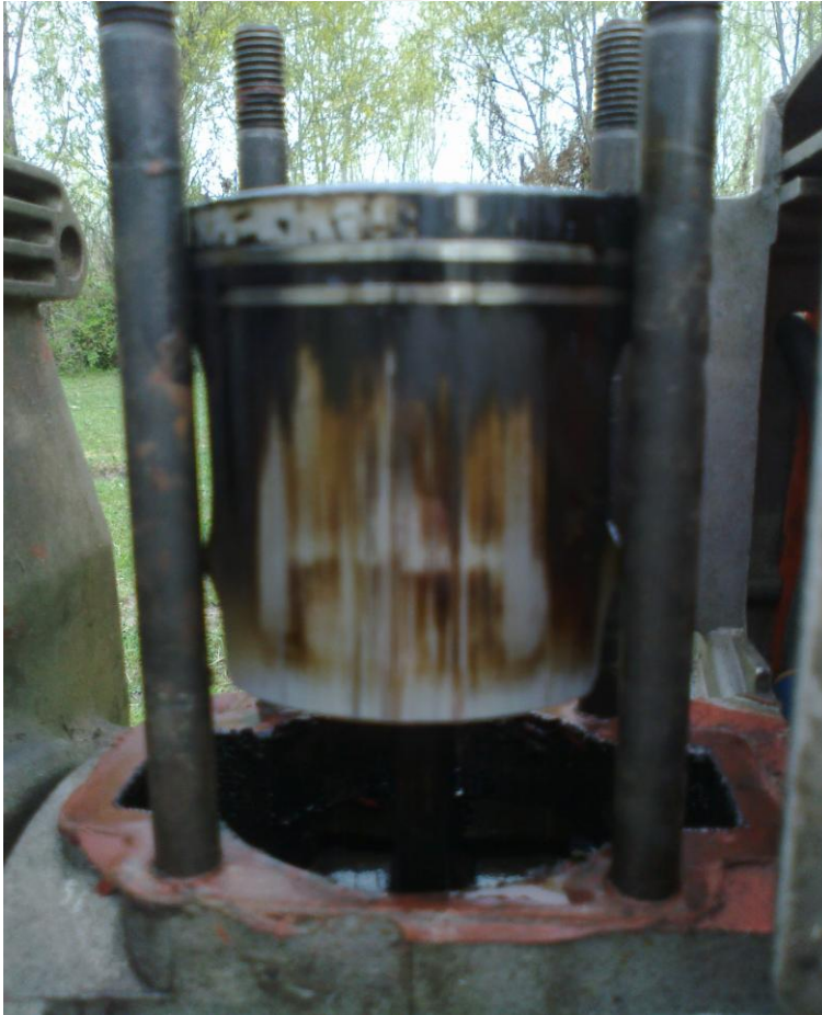
Şekil 5.6. Deney motorunun benzin-kanola yağı karışımı ile çalıştırılması sonucu piston görüntüsü
