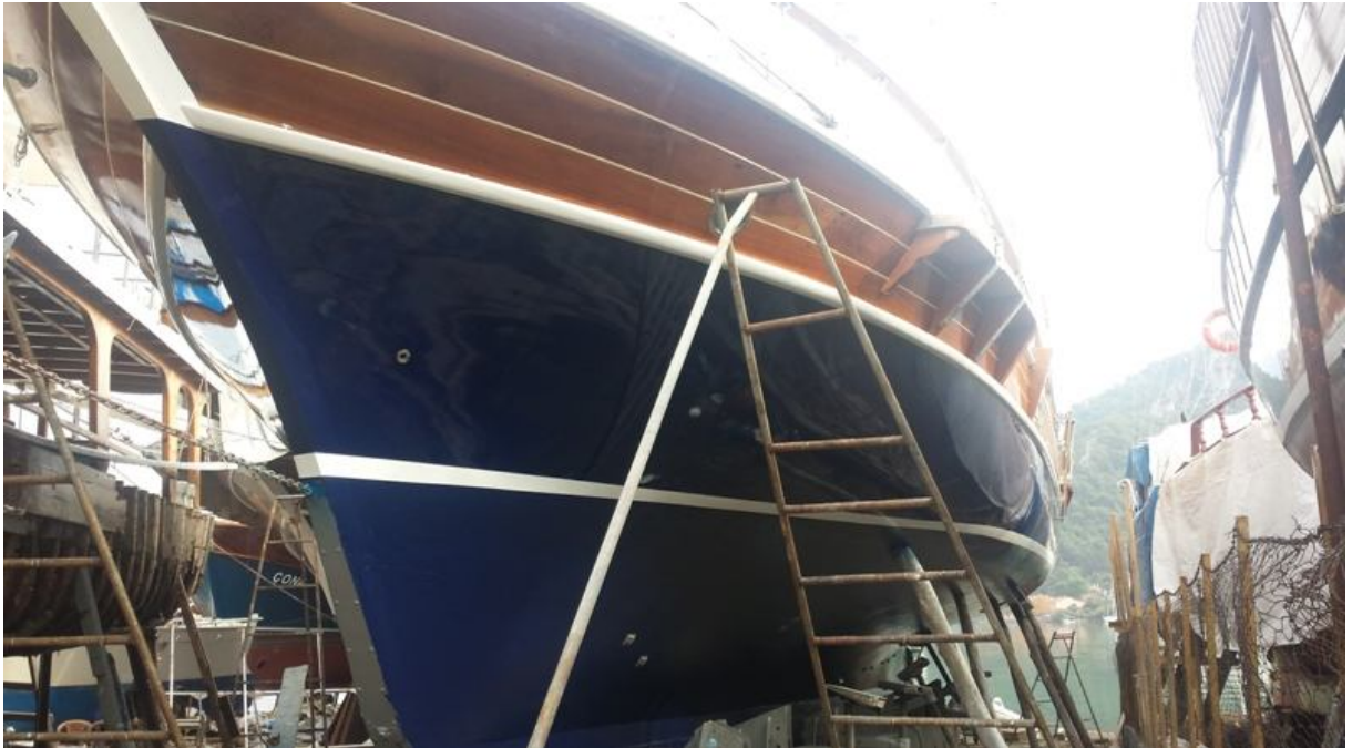
Şekil 4.3. Epoksi reçine ile kalıplama işlemi yapılmış bir tekne.
