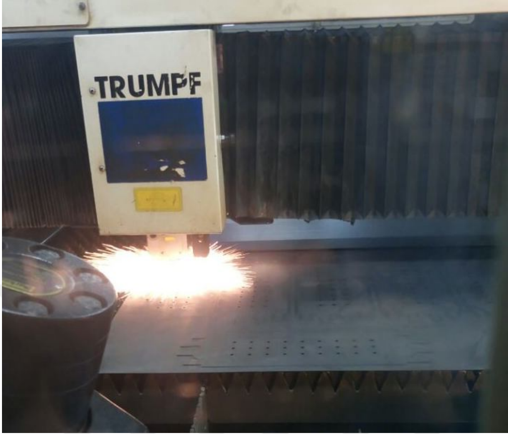
Şekil 6.2. Alüminyum malzemelerin CNC laser kesme tezgahında kesilmesi.
