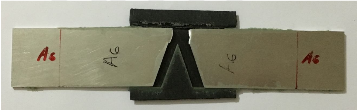
Şekil 7.27. Tek tarafı yamalı çentikli numunenin çekme testi sonucu oluşan hasarın önden gösterimi.
