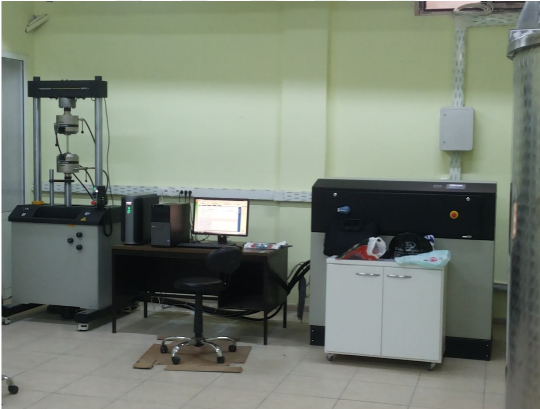
Şekil 6.19. Deney yapılan tüm numunelerin çekme testine tabi tutulduğu çekme testi cihazı.
