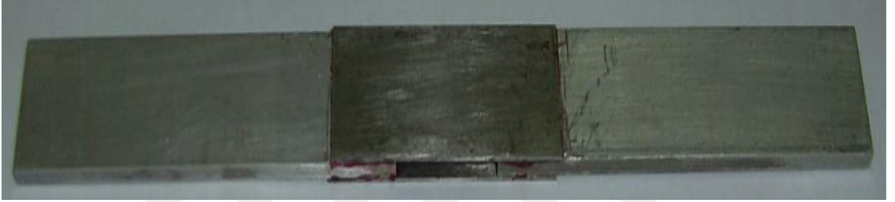
Şekil 5.12. 2024-T3 Alüminyum levhanın karbon çeliğiyle ile birleştirilmesi [9].
