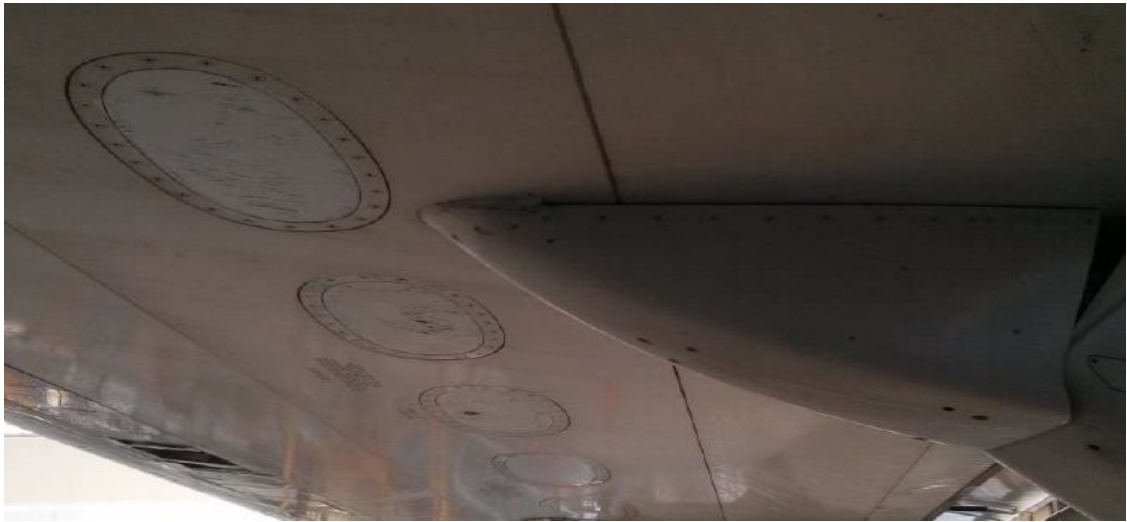
Şekil 5.16. Uçak kanat altında yamalı tamir işlemi bitmiş görüntüsü [5].
