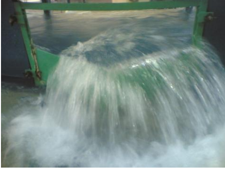
Şekil 4.15. Labirent yan savağın büyük açılarında ve büyük Fr sayılarında yan savağın üzerindeki nap yükü
