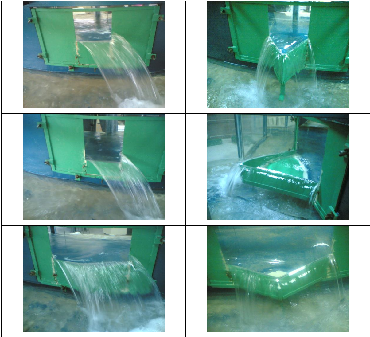
Şekil 4.9. Dikdörtgen ve labirent yan savak üzerinde yanal akım
