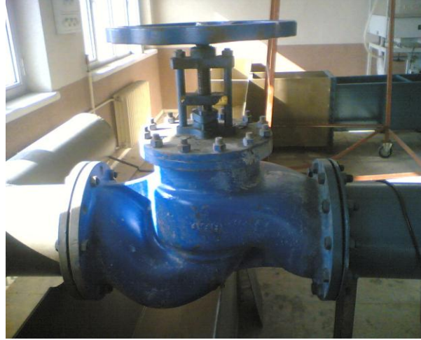
Şekil 3.6. Giriş debisinin ayarlandığı debimetrenin ön kısmındaki vana
