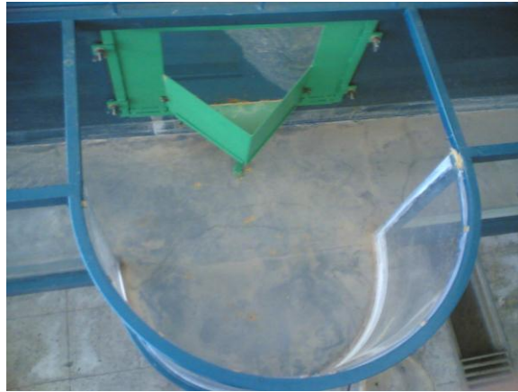
Şekil 3.1 Yan savağın karşısında toplama kanalı
