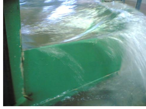
Şekil 4.15. Labirent yan savağın büyük açılarında ve büyük Fr sayılarında yan savağın üzerindeki nap yükü
