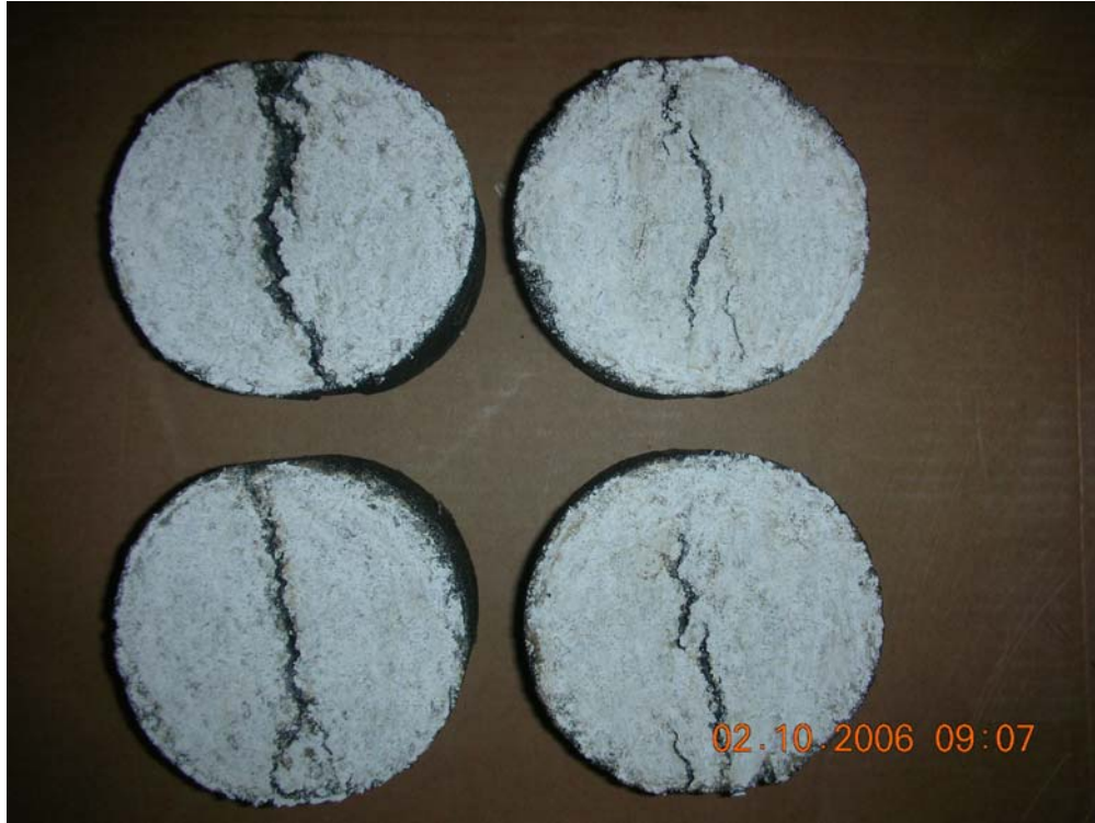
Şekil.5.58. Yorulma deneyi sonrası kırılmış numuneler.
