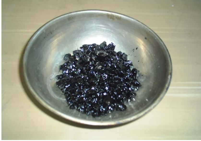
Şekil 5.28. Birinci aşama sonrası yüzeyi kaplanmış olan kaba agreg.
