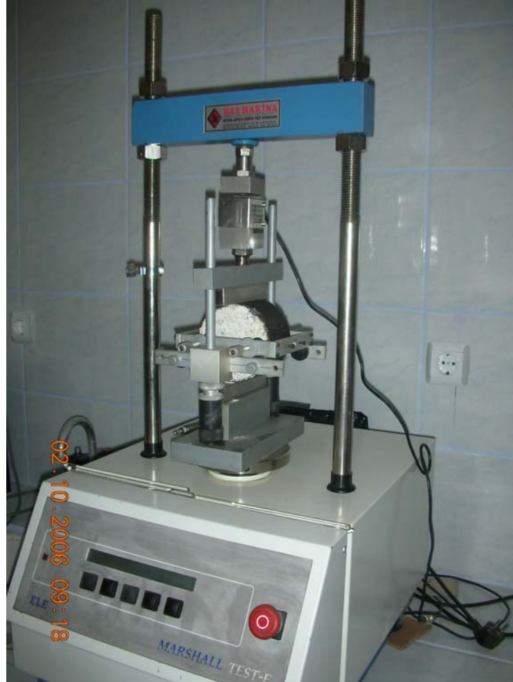
Şekil 5.32. İndirek çekme mukavemeti deney düzeneği.
