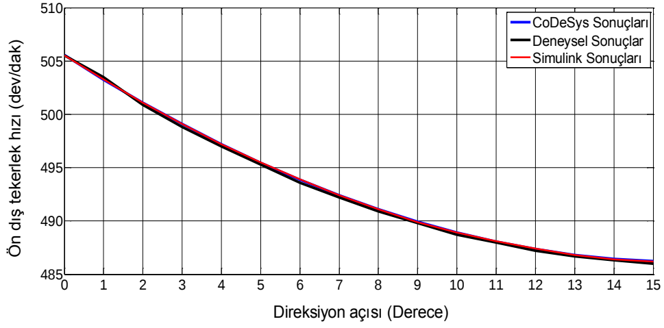
Şekil 4.39. Ön dış tekerlek hızının CoDeSys, deneysel çalışma ve Simulink sonuçlarının karşılaştırması
