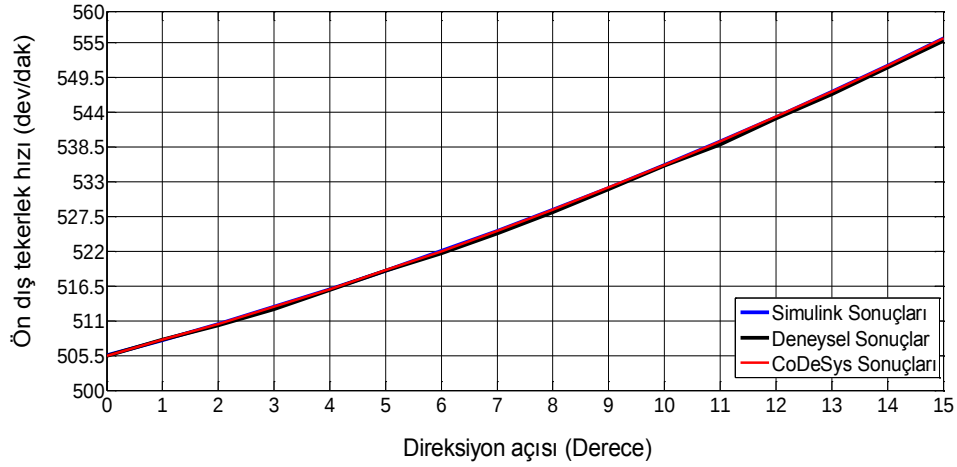
Şekil 4.37. Ön dış tekerlek hızının CoDeSys, deneysel çalışma ve Simulink sonuçlarının karşılaştırması
