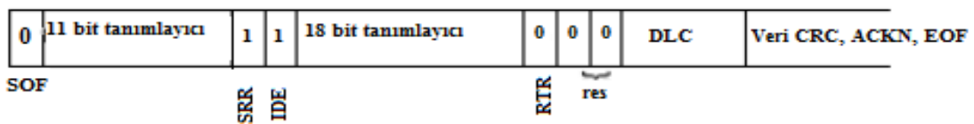
Şekil 3.14. Genişletilmiş CAN-BUS veri çerçeve yapısı [16].
