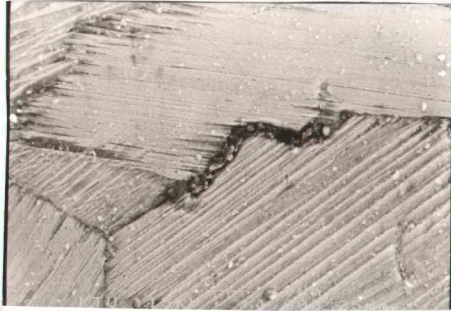
Şekil 7.28: 100°C de kaynayan suda kademeli-soğutulan ve bu sıcaklıkta 1 saat bekletilen ve sonra buzlu suda soğutulan numuneye ait çökelti fazları (x1000).
