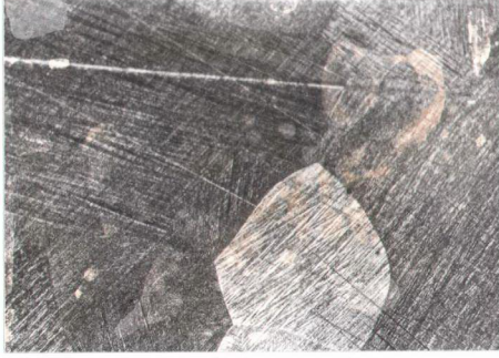
Şekil 7.51: Kaynayan su içerisinde 1 saat bekletildikten sonra buzlu su içerisinde soğutulan numuneye ait birbiriyle uyumlu plaka grupları ve çökelti oluşumu (x100).
