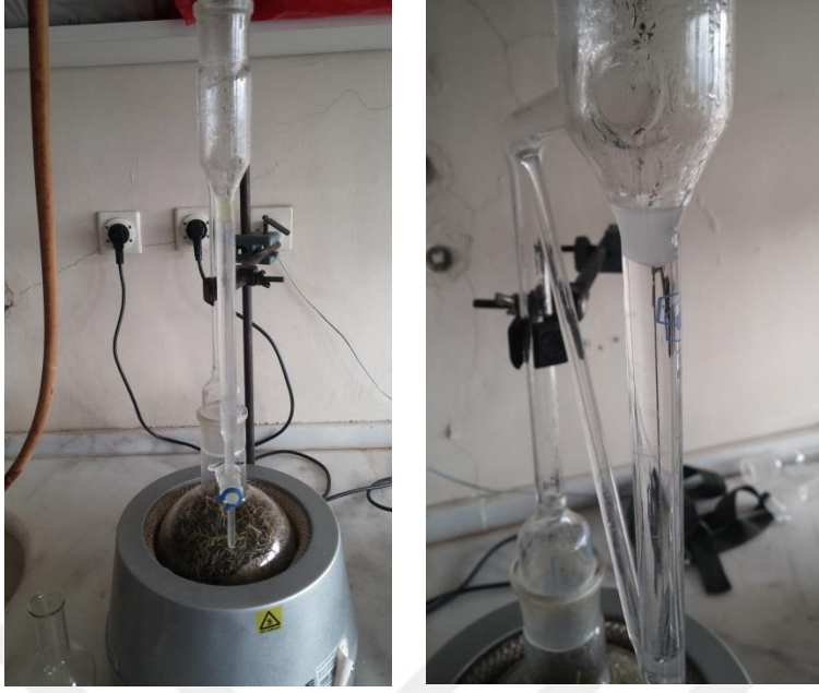
Şekil 2.4. Clevenger apareyi ile uçucu yağ eldesi
