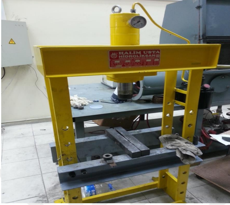
Şekil 4.3 Deneysel çalışmalarda kullanılan hidrolik pres cihazı
