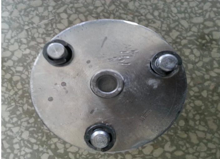
Şekil 4.2 Deneysel çalışmalarda kullanılan tek eksenli toz sıkıştırma kalıbı
