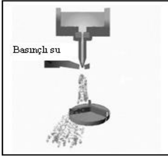
Şekil 3.11 Döner disk atomizasyon yöntemi
