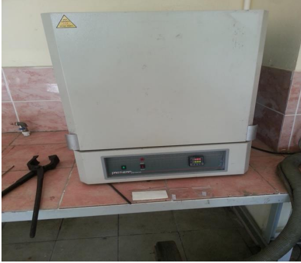
Şekil 4.5 Protherm marka sinterleme fırını
