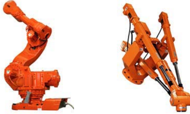
Şekil 2.4. Seri robot (solda) ve paralel robot (sağda) [24].
