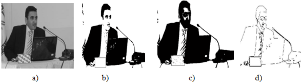
Şekil 3.6. a) Resim, b) Eşik değeri =80, c) Eşik değeri=120, d) Uyarlanabilir Eşik
