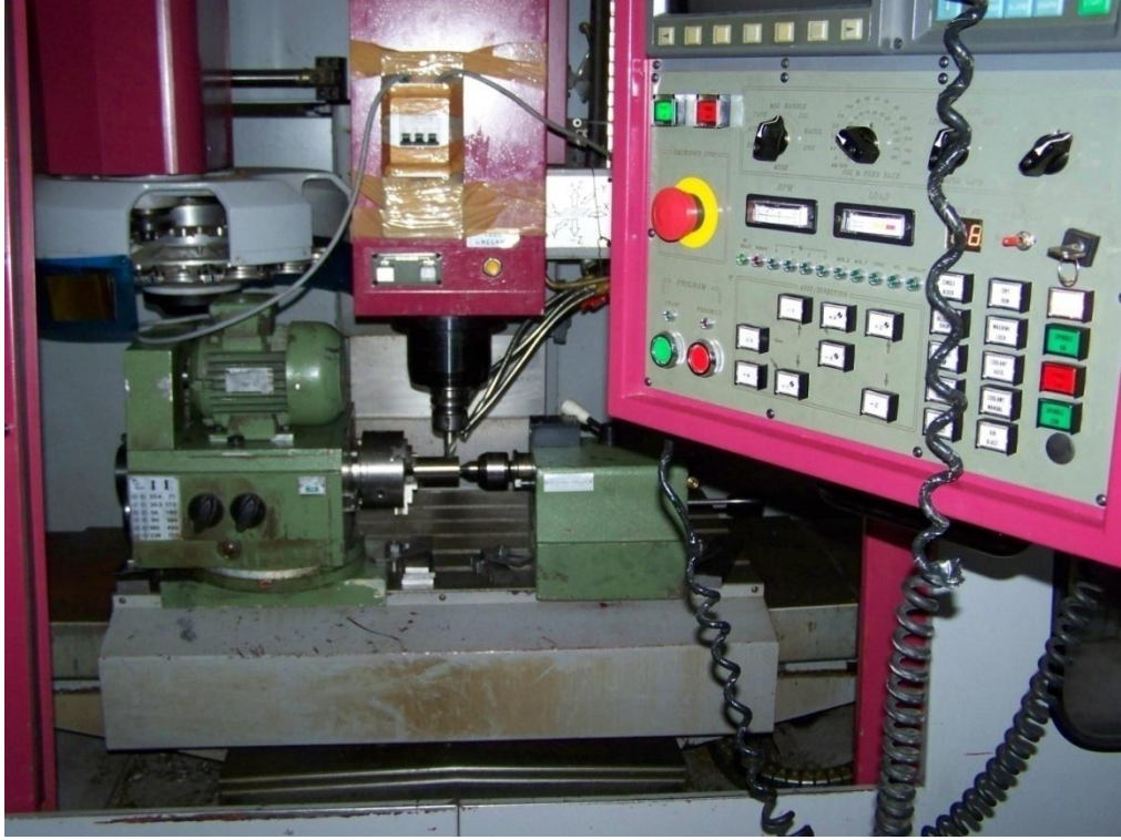
Şekil 5.1. Teğetsel tornalama-frezeleme deney düzenek fotoğrafı
