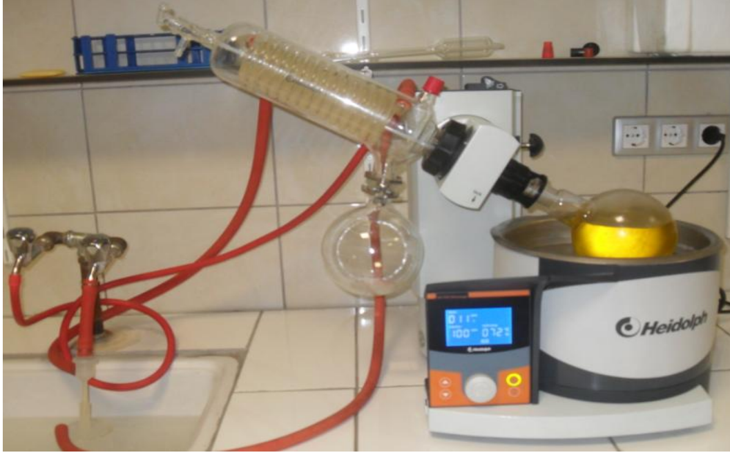
Şekil 3.2. Yağın ve biyodizelin içeriğindeki olası nemin uzaklaştırıldığı buharlaştırma işlemi
