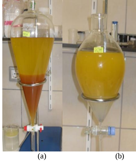
Şekil 3.4. Üzüm çekirdeği yağı için; (a) faz ayrışması, (b) yıkama işlemi
