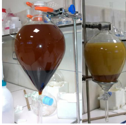
Şekil 3.7. Ceviz yağı için; (a) faz ayrışması, (b) yıkama işlemi
