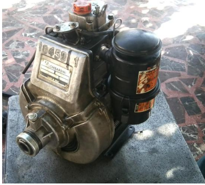
Şekil 5.41. Deneylerde kullanılan 6 LD 400 Lombardini marka motorun genel görüntüsü
