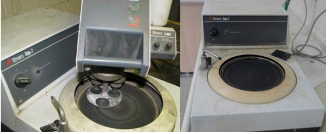
Şekil 5.54 Zımparalanma işleminin yapıldığı Steruers Dap-7 marka cihaza ait görüntü
