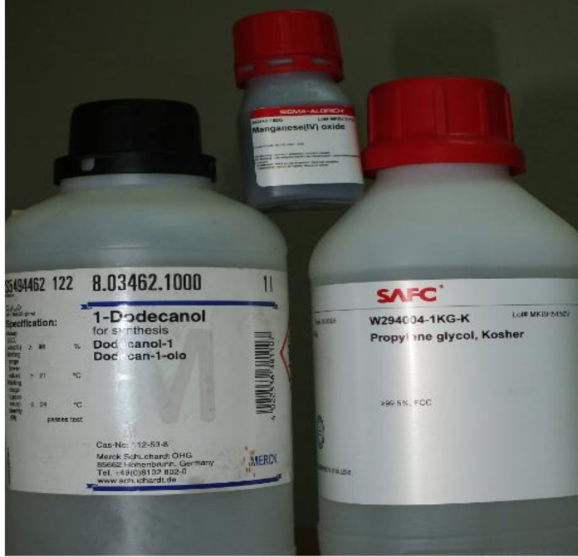
Şekil 3.11. Çalışmada kullanılan yakıt katkı maddeleri (Mn, dodekanol ve propilen glikol)
