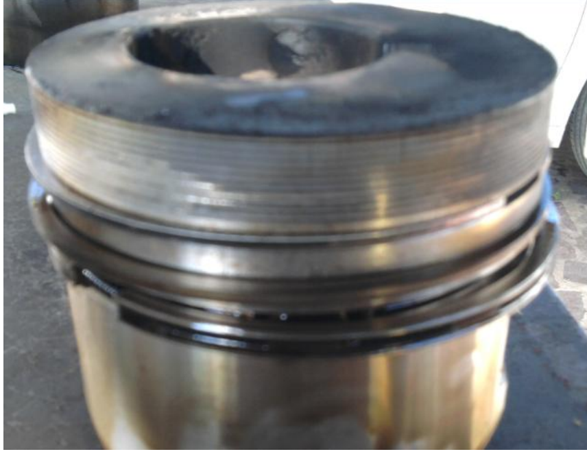
Şekil 5.50. B50 yakıtı ile çalışma sonrası piston-segman takımının görünümü
