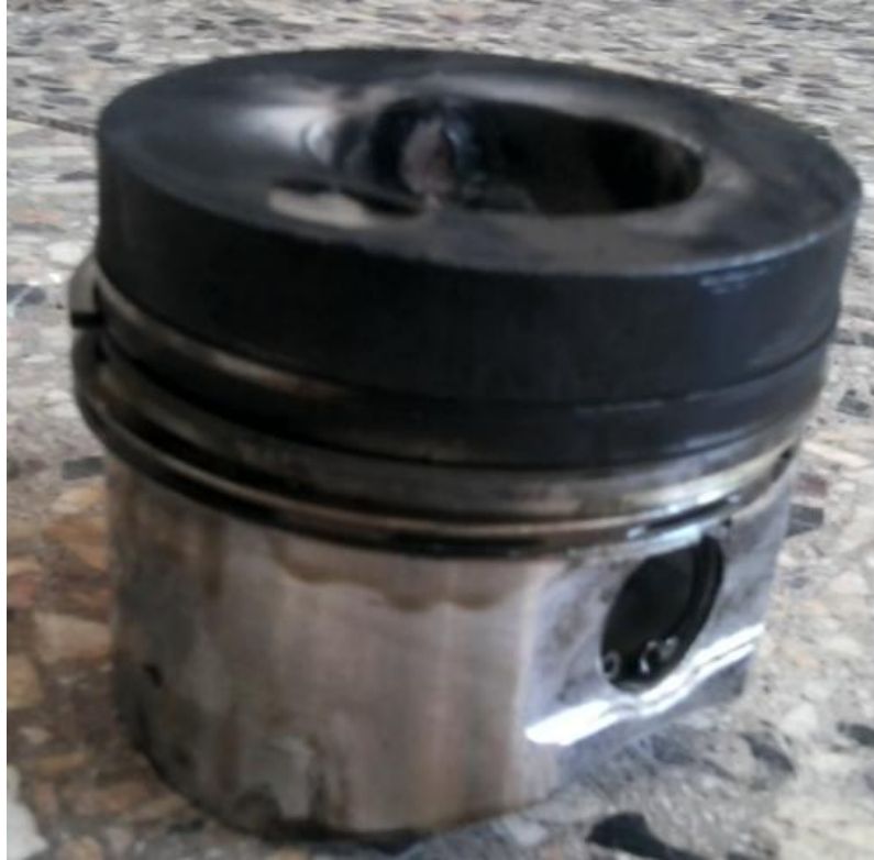
Şekil 5.44. Dizel yakıtı ile çalışma sonrası piston-segman takımının görünümü
