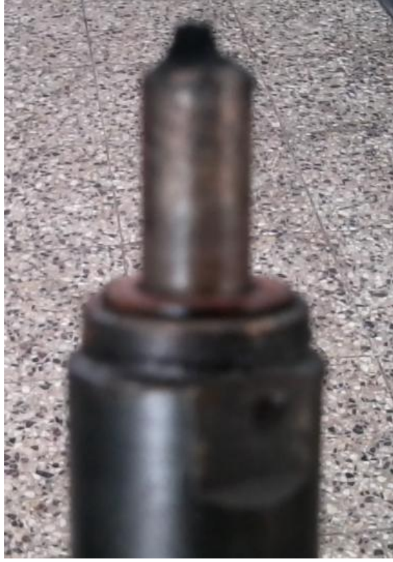
Şekil 5.48. B50 yakıtı ile çalışma sonrası yakıt enjektör ucunun görünümü
