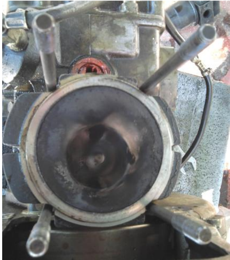
Şekil 5.49. B50 yakıtı ile çalışma sonrası silindir üst yüzeyinin görünümü
