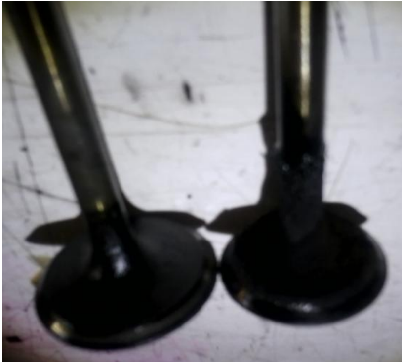
Şekil 5.53. B50 yakıtı ile çalışma sonrası supapların görünümü
