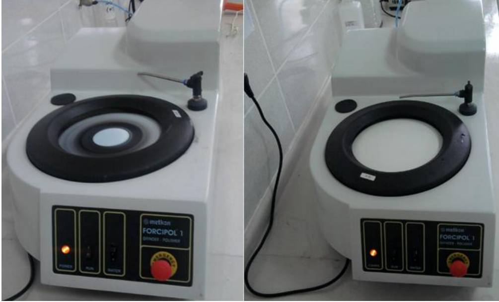
Şekil 5.55. Çuhalama işleminin yapıldığı, Metkon FORCIPOL-1 marka cihaza ait görüntü
