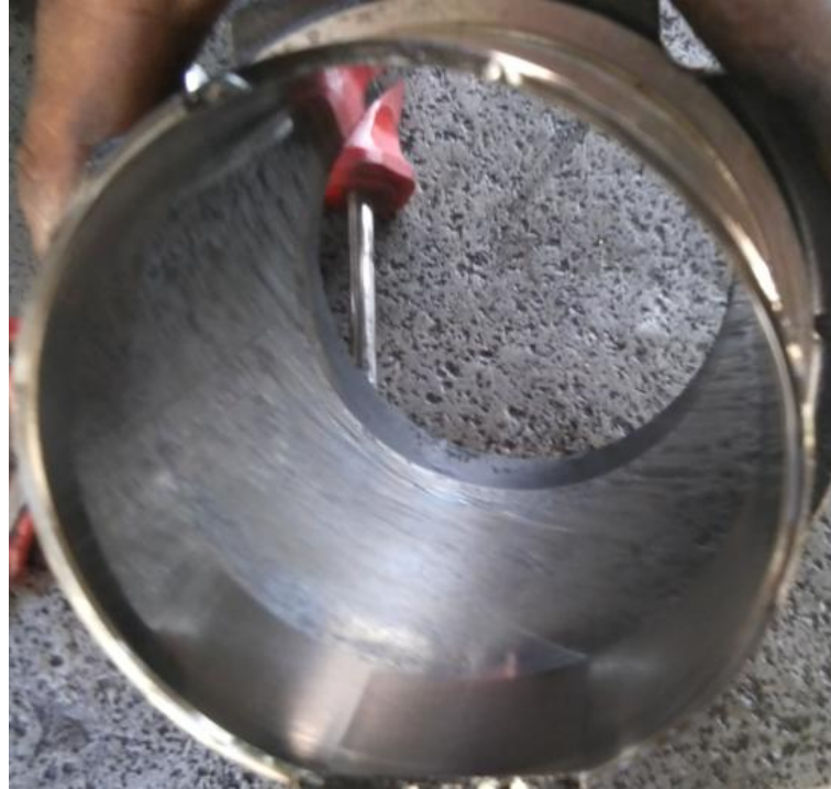
Şekil 5.51. B50 yakıtı ile çalışma sonrası silindir gömleğinin görünümü
