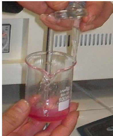
Şekil 3.1. Serbest yağ asidi tayinindeki titrasyon işlemi
