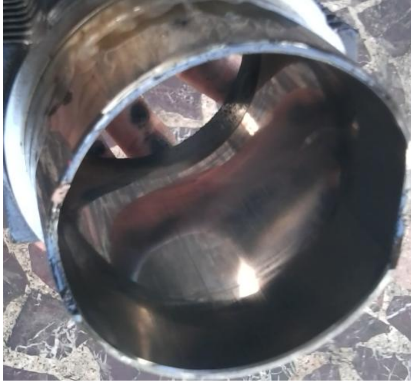
Şekil 5.45. Dizel yakıtı ile çalışma sonrası yakıt silindir gömleğinin görünümü
