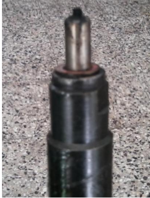
Şekil 5.42. Dizel yakıtı ile çalışma sonrası yakıt enjektör ucunun görünümü
