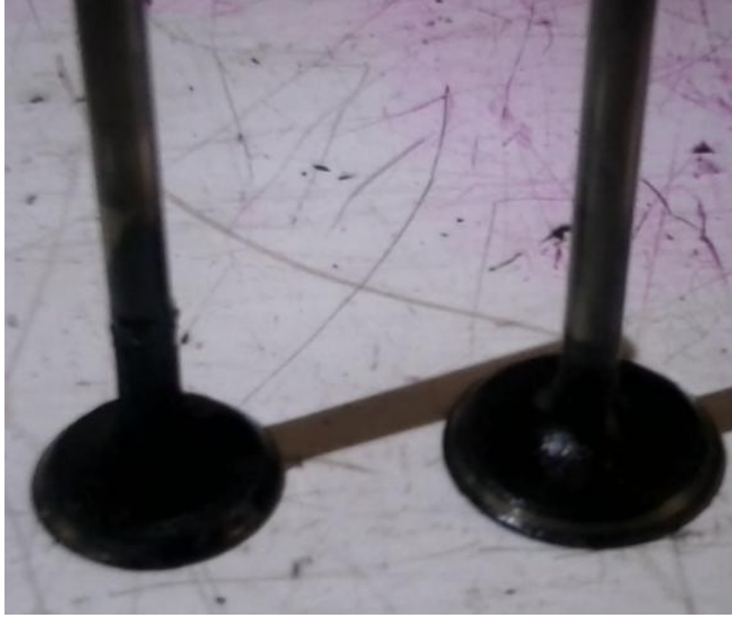
Şekil 5.47. Dizel yakıtı ile çalışma sonrası supapların görünümü
