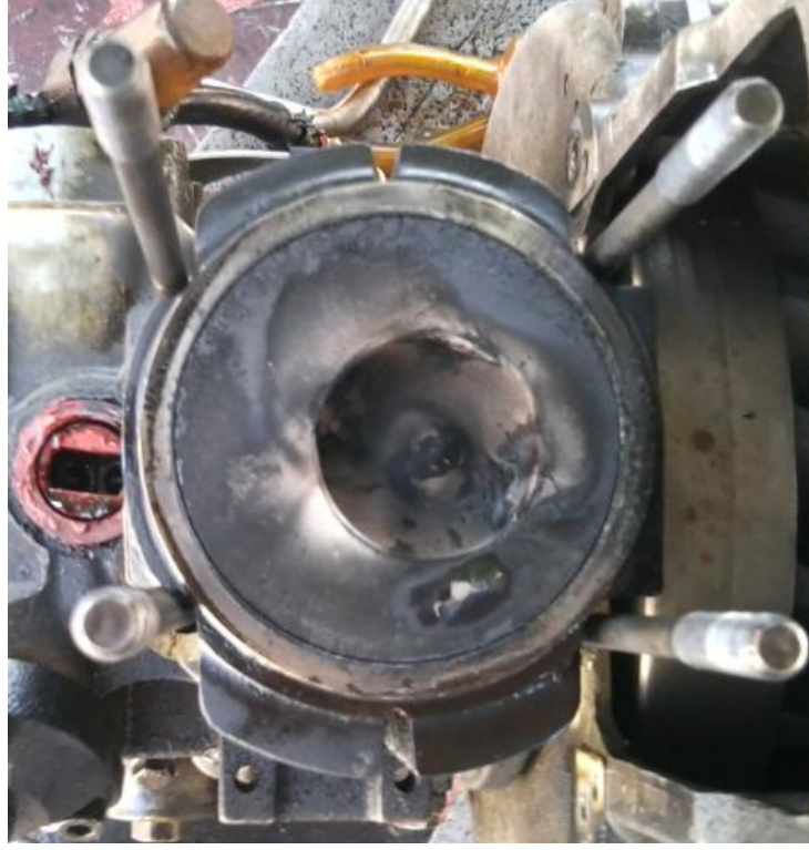
Şekil 5.43 Dizel yakıtı ile çalışma sonrası silindir üst yüzeyinin görünümü
