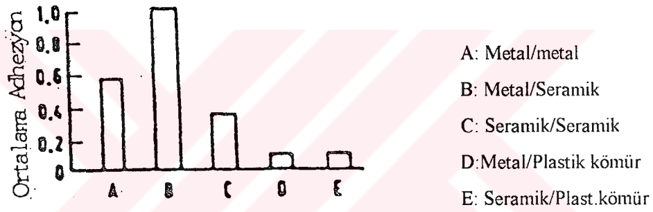
Şekil 6.7 Kellog'a Göre Farklı Malzeme Çiftlerinin Adhezyonu.
