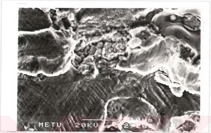
Şekil 9.22. P4 Numunesinin Yorulma Kırık Yüzeyinin SEM Fotoğrafı (X 2200).
