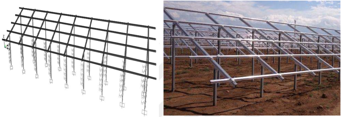
Şekil 2.4. Arazi tipi konstrüksiyon sistemi ve uygulaması
