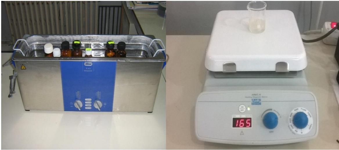
Şekil 2.3. Değişken devirli ultrasonik karıştırıcı da ve ısıtıcılı manyetik karıştırıcıda karışımların hazırlanması
