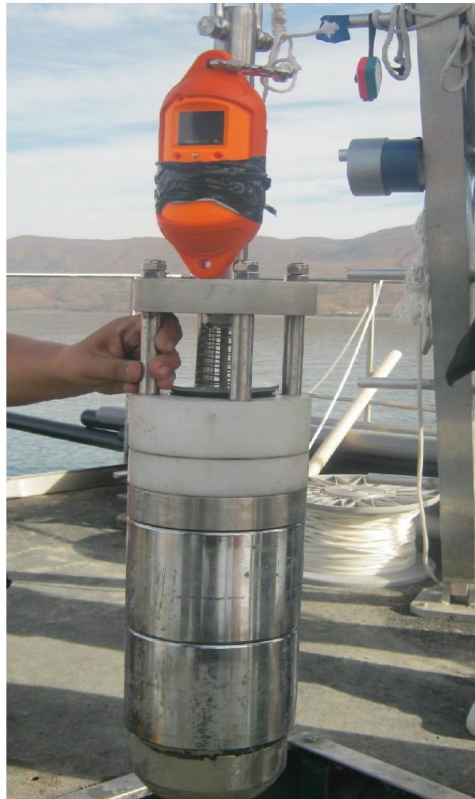
Şekil 3. Çalışmada kullanılan piston çakmalı sistem ve CTD aletinden bir görünüm
