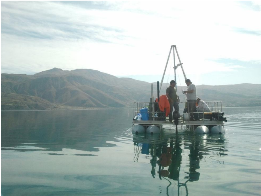
Şekil 2. Arazi çalışması karot alımında kullanılan platform
