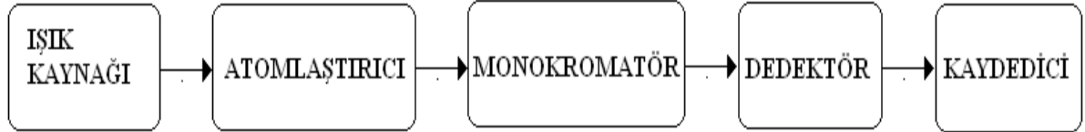
Şekil 3.2. Atomik Absorpsiyon Spektroskopisi cihaz şeması
