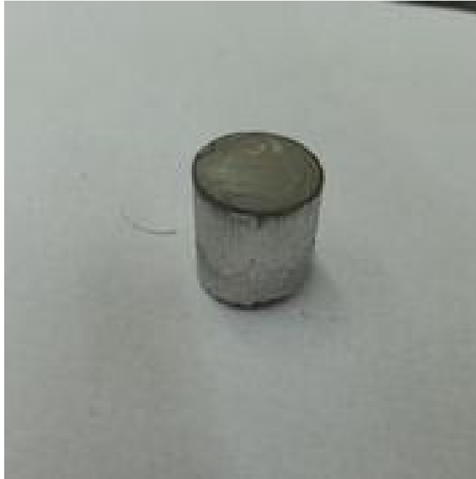
Şekil 3.2. Soğuk preslenmiş silindirik numuneler
