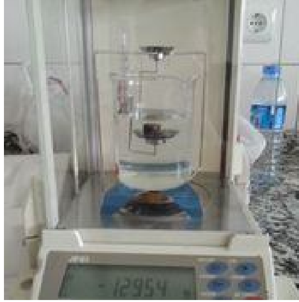
Şekil 3.5. Numunelerin yoğunluk ölçümlerinin yapıldığı AND-GR200 cihazı
