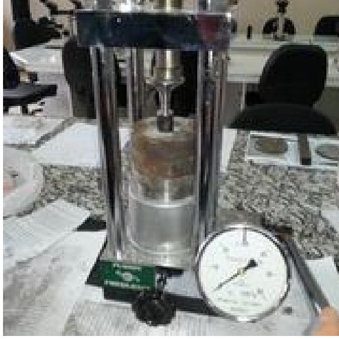
Şekil 3.1. Numunelerin soğuk preslenmesi
